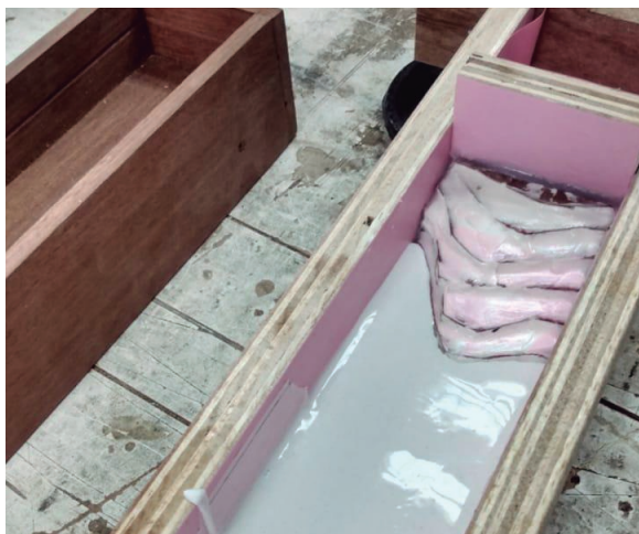
Imagem 48 | Processo de produção das peças em gesso a partir de molde de papelão
