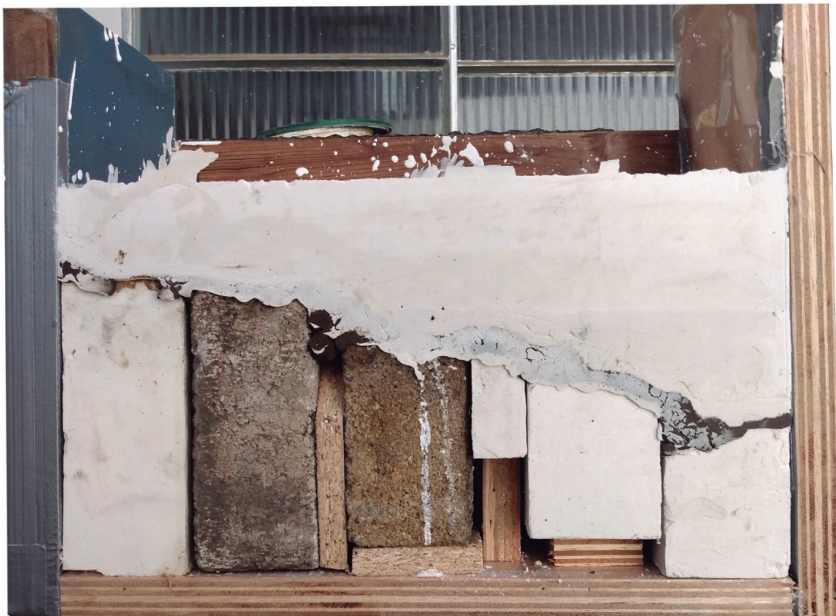
Imagem 44 | Exemplo de molde. Na parte de baixo estão pedaços de tijolos, gesso, madeira, argila e silicone. Na parte de cima está a peça de cimento branco após o processo de endurecimento (cura).
