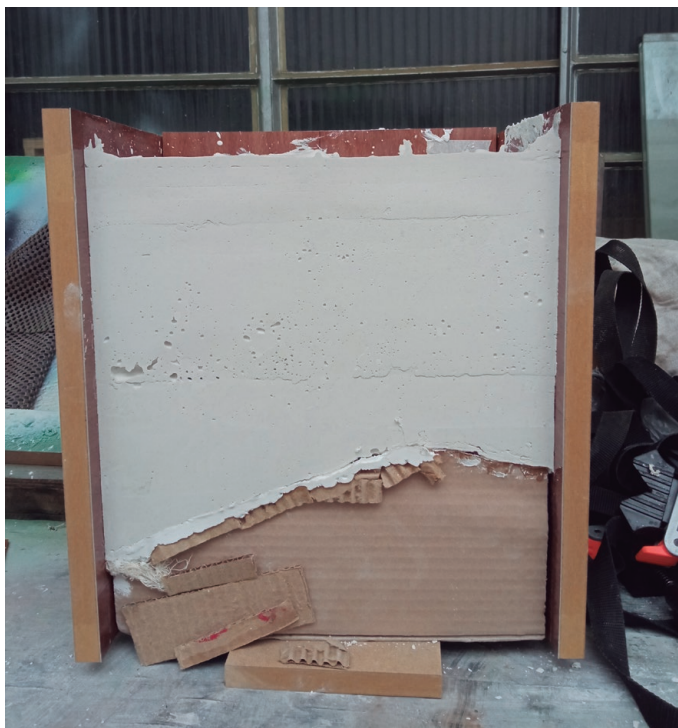
Imagem 47 | Exemplo de molde. Na parte de baixo papelão e na parte de cima peça de cimento branco após o processo de endurecimento (cura).
