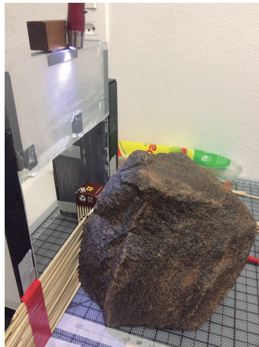
Imagem 28 | Ferramenta desenvolvida para capturar os contornos da pedra, 2017
