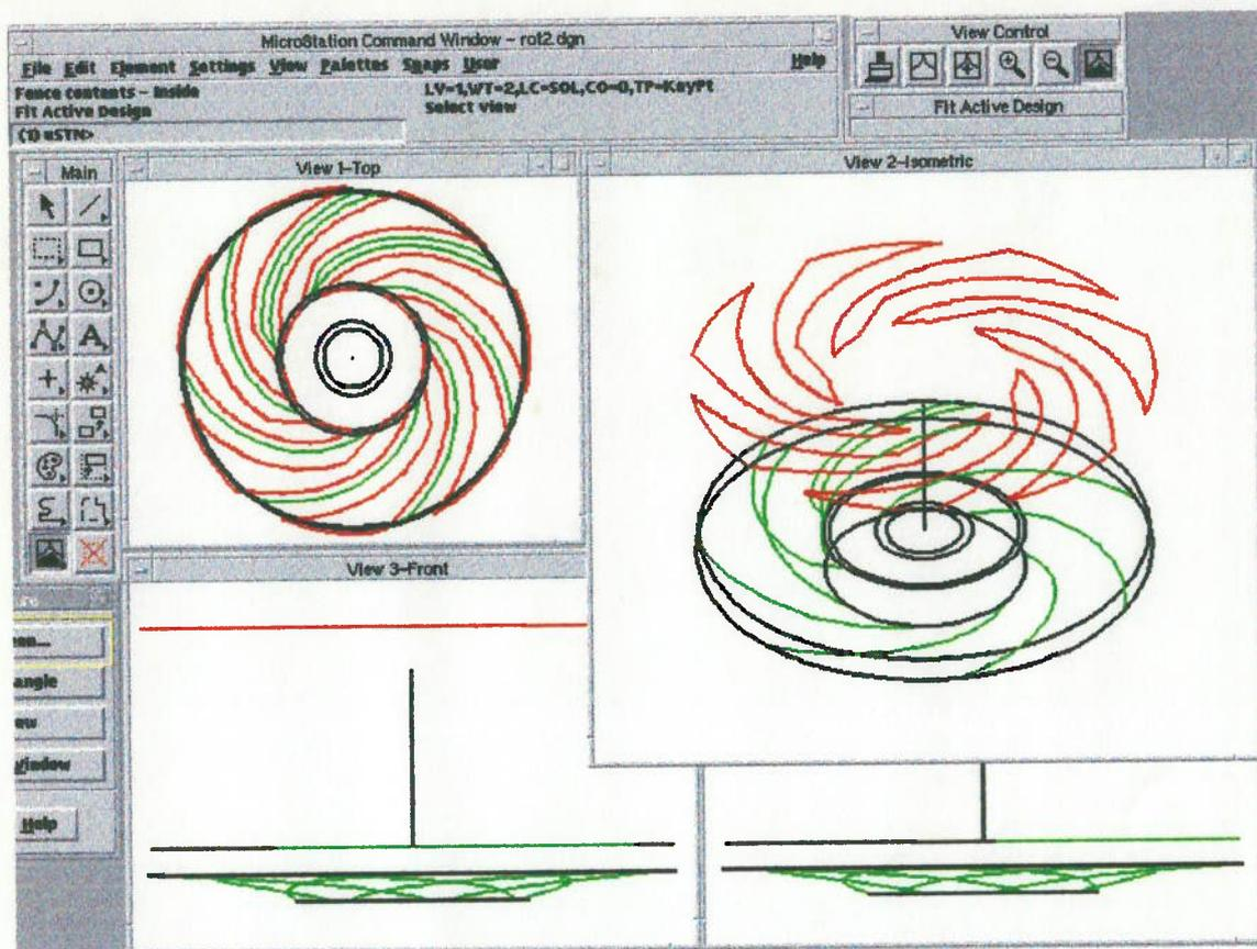
Figura 22. Tela capturada com uso do aplicativo CAD Microstation - Contornos que definem as cavidades a ser projetadas na superfície de revolução gerada pela rotação do perfil de uma pá do rotor.
