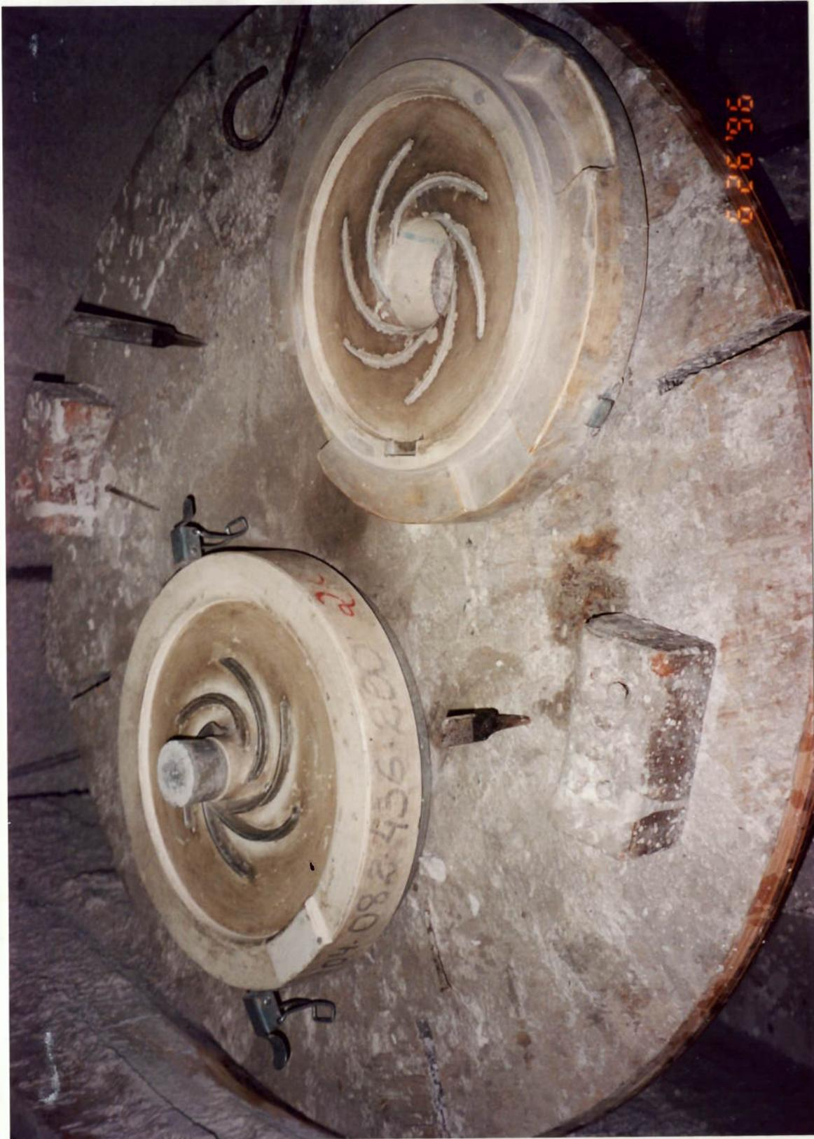
Fotografia 4. Molde para confecção de macho de material cerâmico.
