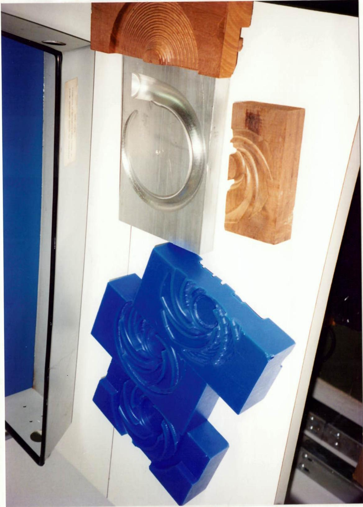
Fotografia 8. Moldes em diversos materiais com variações no caminho da ferramenta. Cera em azul, alumínio e madeira.
