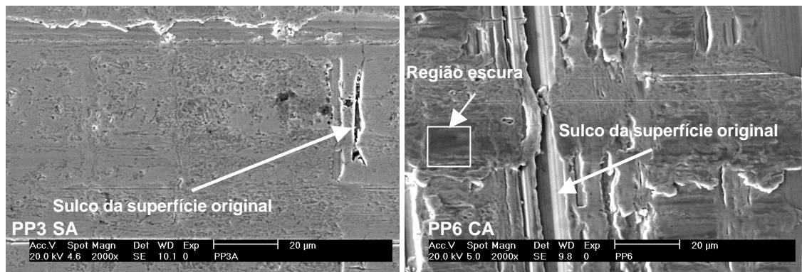
Figura 4-19: Aparência microscópica da trilha de desgaste de placas após ensaio na condição PP, região próxima à extremidade lateral. Imagens de elétrons secundários.
