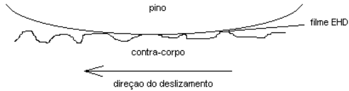
Figura 5-12: Esquema ilustrativo do contato deslizante e a localização do filme EHD (ou EHL).
