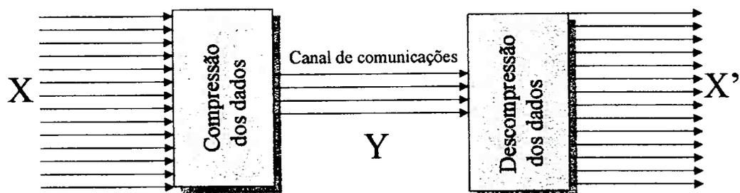
**Figura 18.** Compressão de dados para serem enviados através de um canal de comunicações. Espera-se que após a descompressão da informação enviada pelo canal de comunicações o padrão reconstruído  $X'$  seja o mais parecido possível ao padrão inicial  $X$ .
