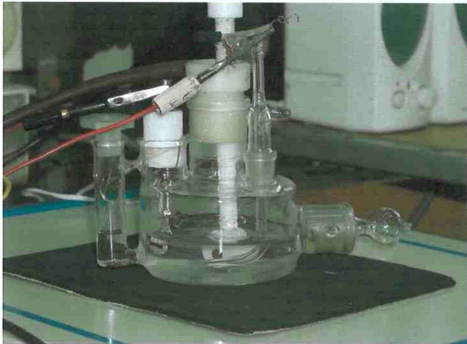
Figura 4.5 montagem de célula para experimento com eletrodo planar de cobre
