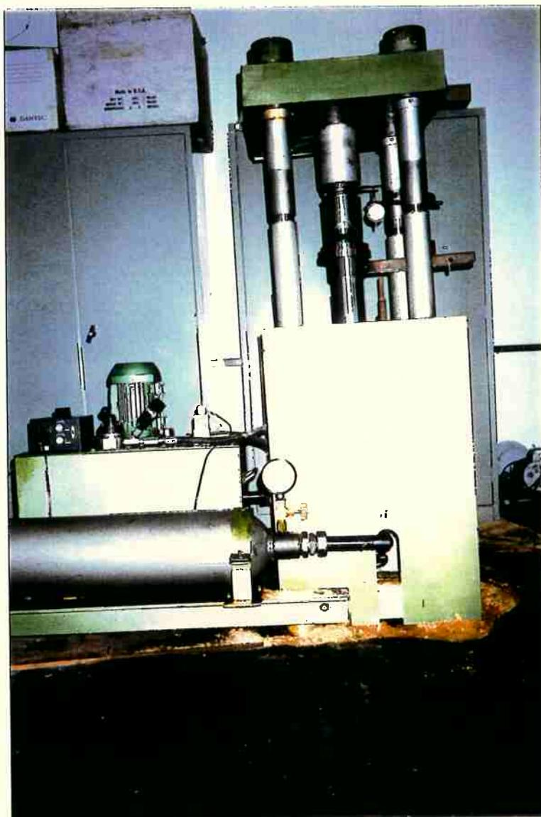
Figura 5.5 Prensa hidráulica para forjamento e estampagem, Laboratório de Processos de Fabricação do Departamento de Engenharia Mecânica da EPUSP.
