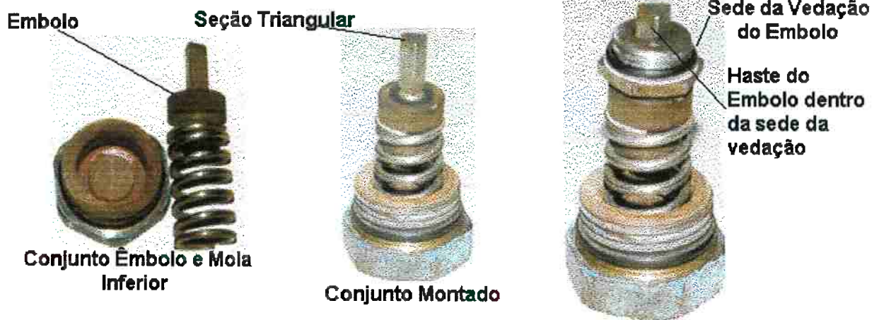
Figura 3.25 – Conjunto do embolo e mola de retorno inferior
