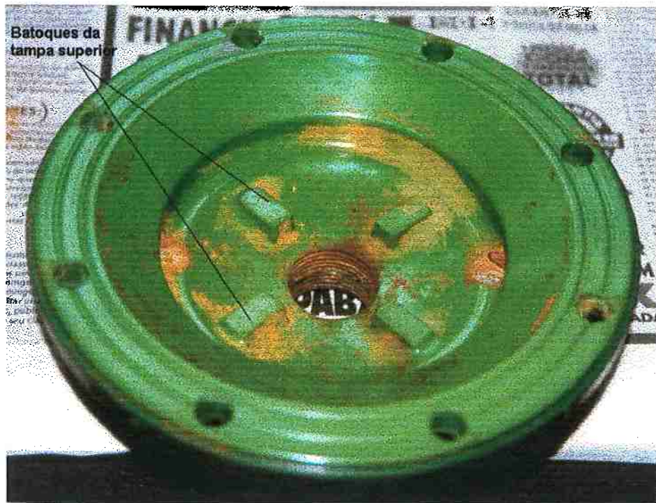
Figura 3.11 – Tampa Superior da Câmara do Diafragma da VCA
