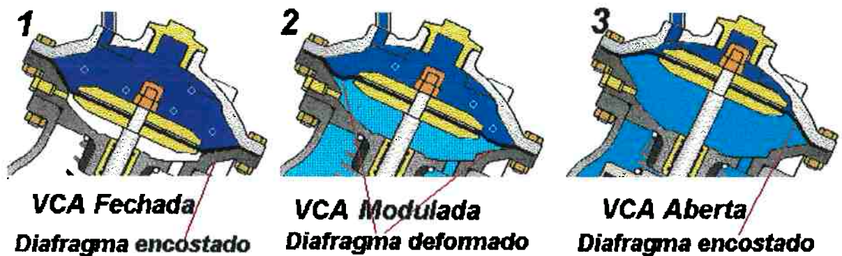
Figura 4.14 - Posições do diafragma dentro da Câmara da VCA.
