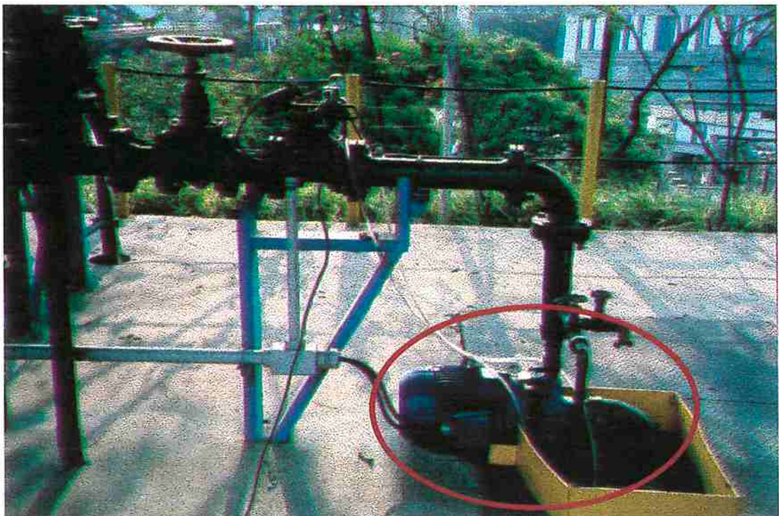
Figura 5.6 – Bomba da rede da bancada de Testes
