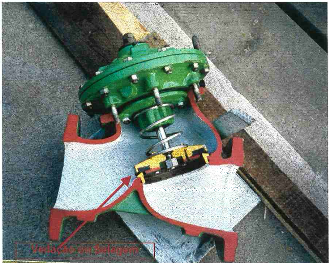
Figura 3.7- VCA de 3 polegadas em corte – Válvula Modelada e Ensaída
