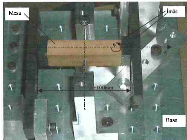
Figura 6.21: ( b \gg h ) e a mesa mantém-se alinhada e permanece nesta posição (estável em \phi ).
