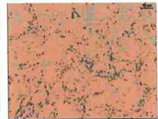
Fig. 38.A1. Contraste de cores da Fig. 38.A: Matriz martensítica (ocre), austenita retida e carbonetos (cinza), carbonetos e sulfetos (pontos pretos)
