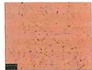
Fig. 45.B1. Contraste de cores da Fig. 45.B: Matriz martensítica (ocre) e carbonetos (zonas escuras)
