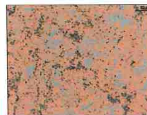
Fig. 35.A1. Contraste de cores da Fig. 35.A: Matriz martensítica (ocre), austenita retida e carbonetos (cinza), carbonetos e sulfetos (pontos pretos)
