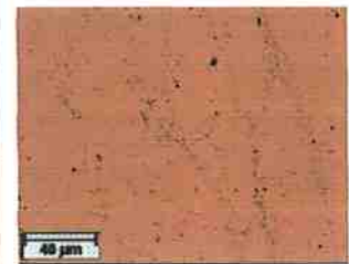
Fig. 45.A1. Contraste de cores da Fig. 45.A: Matriz martensítica (ocre), e carbonetos (zonas escuras)
