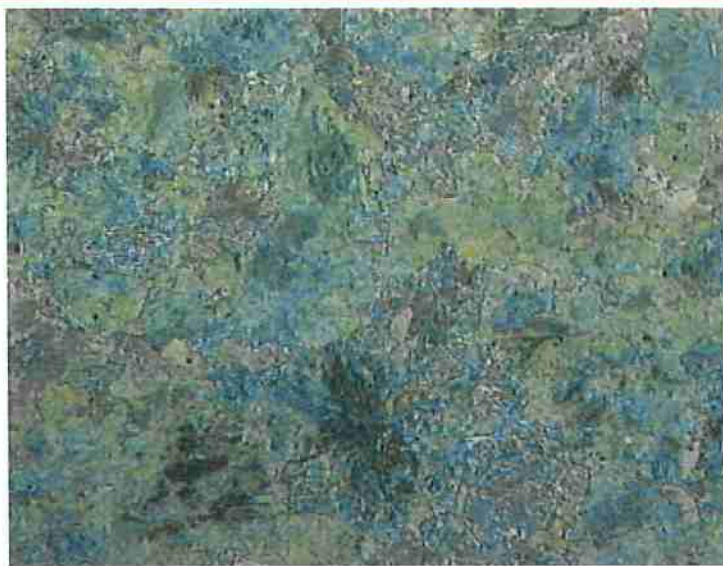
Figura 33.A. Aço AISI 52100, na condição recebida, grãos de perlita e ferrita -- Nital 1% 150X
