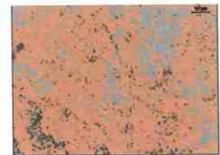
Fig. 36.A1. Contraste de cores da Fig. 36.A: Matriz martensítica (ocre), austenita retida e carbonetos (cinza), carbonetos e sulfetos (pontos pretos)
