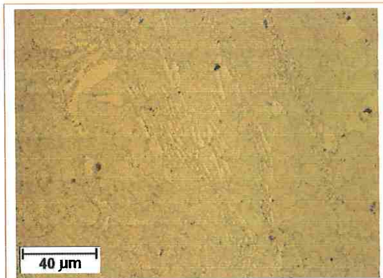
Figura 45.A. Aço AISI M2 importado, após têmpera, dois subresfriamentos e quatro revenimentos (testemunha B42) Ataque:-- Nital 2% Matriz martensítica e malha de distribuição de carbonetos
