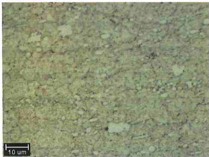
Figura 3.41.B. Aço AISI M2 nacional, após têmpera, dois subresfriamentos e quatro revenimentos (testemunha A16) Ataque:-- Groensbeck Matriz martensítica e malha de distribuição de carbonetos
