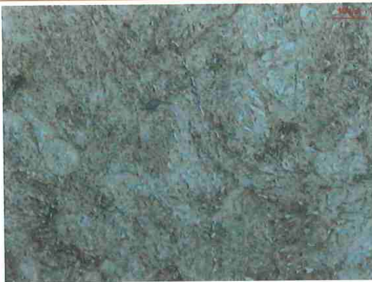
Figura 36.A. Aço AISI 52100QT Ataque: Picral-Nital Matriz martensítica com carbonetos nos contornos de grão e alguns pontos de sulfeto
