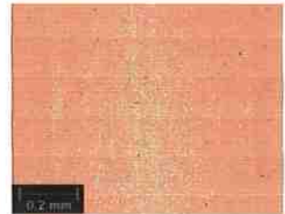
Fig. 41.A1. Contraste de cores da Fig. 41.A: Matriz martensítica (ocre), e carbonetos (zonas verdes e pretas)
