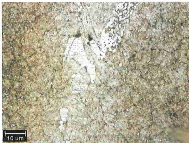
Figura 43.B. Aço AISI M2 importado, após têmpera, dois subresfriamentos e quatro revenimentos (testemunha B37) Ataque:-- Nital 2% Matriz martensítica e malha de distribuição de carbonetos
