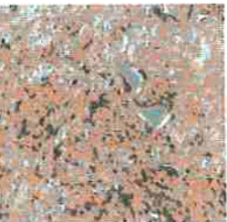
Fig. 37.A1. Contraste de cores da Fig. 37.A: Matriz martensítica (ocre), austenita retida e carbonetos (cinza), carbonetos e sulfetos (pontos pretos)
