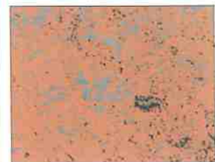
Fig. 34.A1. Contraste de cores da Fig. 34.A: Matriz martensítica (ocre), austenita retida e carbonetos (cinza), carbonetos e sulfetos (pontos pretos)
