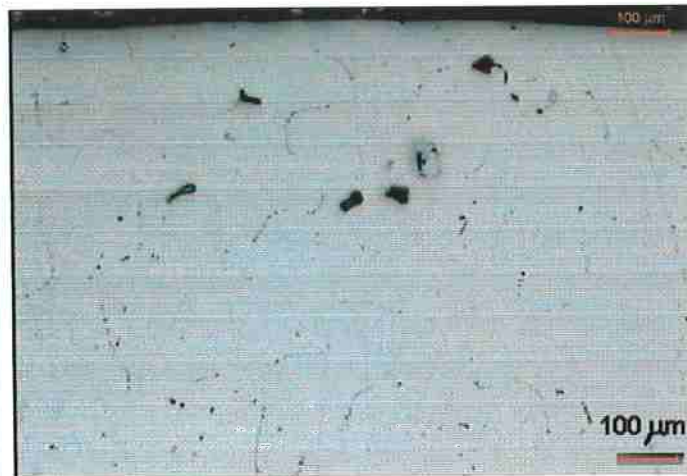
Figura 51. Cobre eletrolítico apresentando glóbulos de óxido cuproso (Cu 2 O) nos contornos de grão e algumas colônias de Cu 2 O e Cu 2 S Sem ataque
