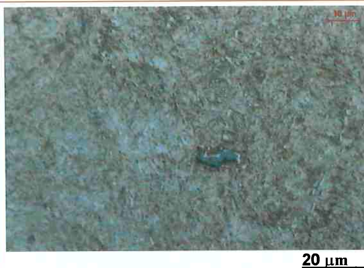
Figura 34.A. Aço AISI 52100OQT Ataque: Nital 1% Partícula escura na zona central: sulfeto
