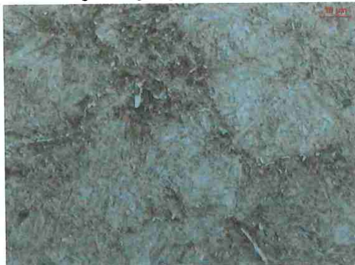
Figura 36.B. Aço AISI 52100QT Ataque: Picral-Nital Matriz martensítica com carbonetos nos contornos de grão e alguns pontos de sulfeto
