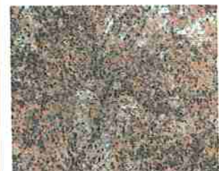
Fig. 37.B1. Contraste de cores da Fig. 37.B: Matriz martensítica (ocre), austenita retida e carbonetos (cinza), carbonetos e sulfetos (pontos pretos)
