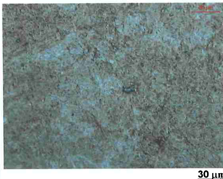
Figura 34.B. Aço AISI 52100OQT Ataque: Nital 1% Partícula escura na zona central: sulfeto
