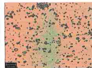
Fig. 40.B1. Contraste de cores da Fig. 40.B: Matriz martensítica (ocre), e carbonetos (pequenas zonas escuras)
