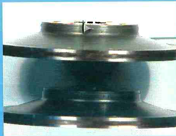
Figura 54. Evolução do dano decorrente do desgaste por contato de rolamento e esquema de registro de janelas temporais do nível de pressão sonora (NPS [dB]) para análise da resposta de irreversibilidades acumuladas pelo material
