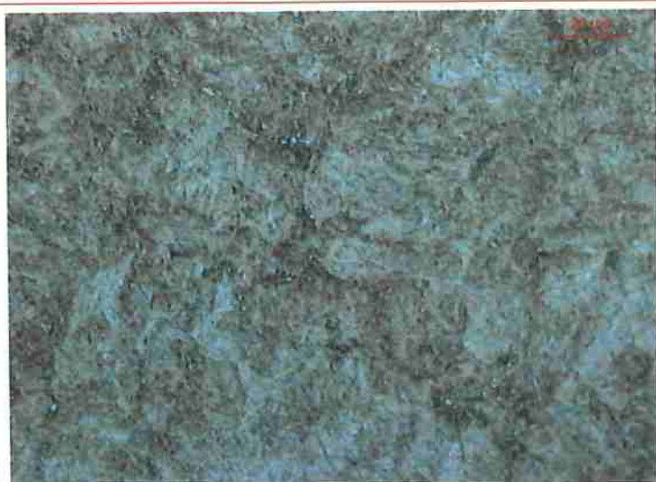
Figura 35.A. Aço AISI 52100QT Ataque: Picral-Nital
