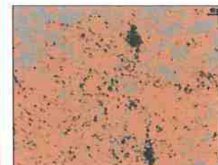
Fig. 36.B1. Contraste de cores da Fig. 36.B: Matriz martensítica (ocre), austenita retida e carbonetos (cinza), carbonetos e sulfetos (pontos pretos)
