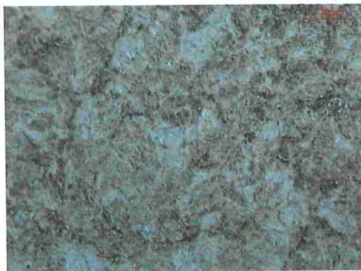
Figura 35.B. Aço AISI 52100QT Ataque: Picral-Nital
