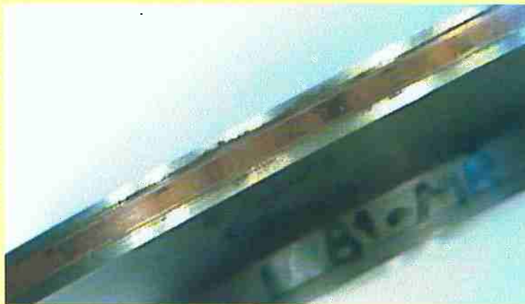
Figura 379. Estado das pistas de contato durante o ensaio ER81 dos discos de Aço AISI 52100 SBQT (motor) após 11,90 Megaciclos,
