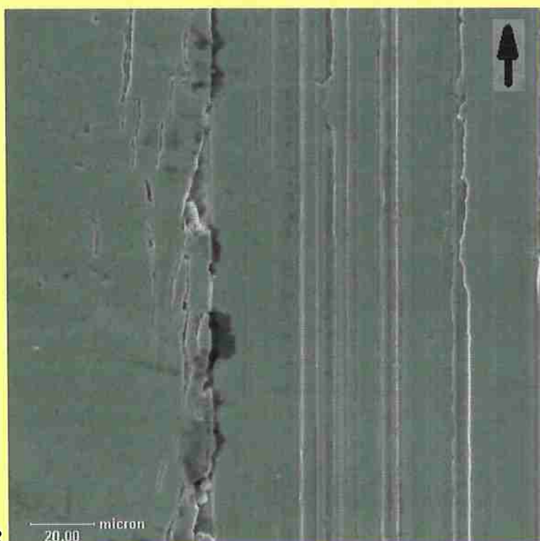
Figura 231. Trincas no meio da pista movida (acima) e na zona de intensificação de tensão da borda da pista motora (embaixo) - 12,6 Megaciclos, 5.931 km
