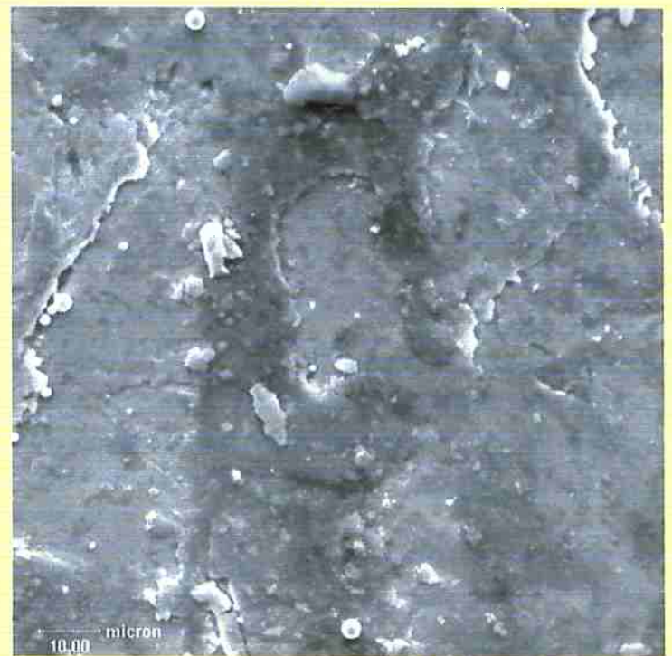
Figura 336. Microtrincas em pista do disco movido, ensaio ER84
