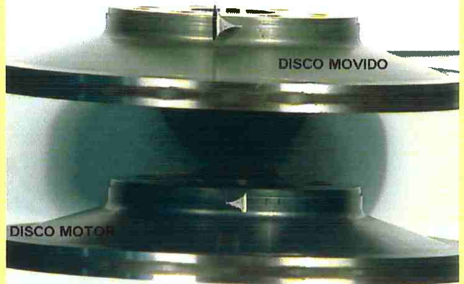
Figura 330. Estado das pistas de contato durante o ensaio ER84 dos discos de Aço AISI 52100 SBQT (motor) e AISI 52100 OQT (movido), após 1,14 Megaciclos, verificando-se que as trilhas já desenvolveram o mecanismo de corrugação ou poligonização , constatado pela presença intercalada de filmes de óxido mais escuros e mais claros
