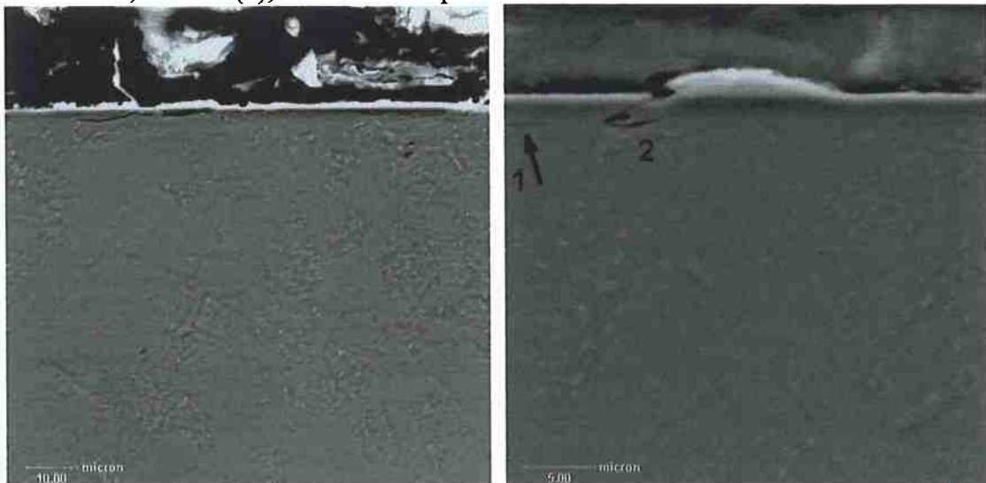
MICROTRINCA 3 \mu\text{m} ABAIXO DA PISTA MOTORA
