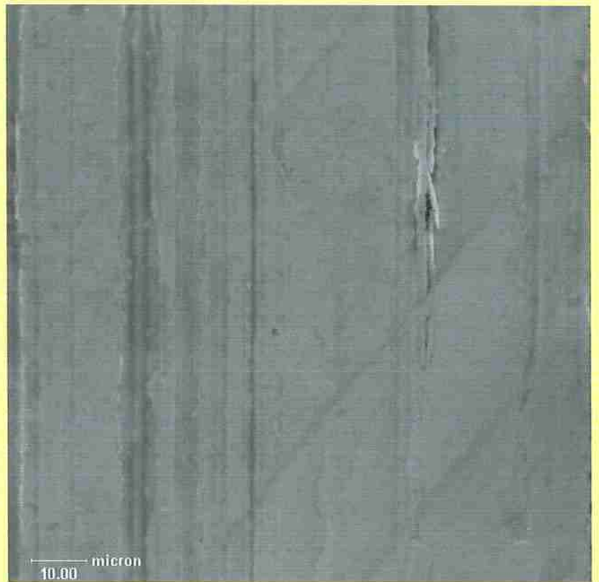
Figura 355. Foto de microscopia eletrônica de varredura da borda da pista movida, após o ensaio ER82, evidenciando expulsão por rolamento de “debris” da zona de contato, sua interação com microtrincas intensificadas pelos sulcos da retificação e pela zona de transição sob carga (contato cíclico) e descarregada (borda da pista)
