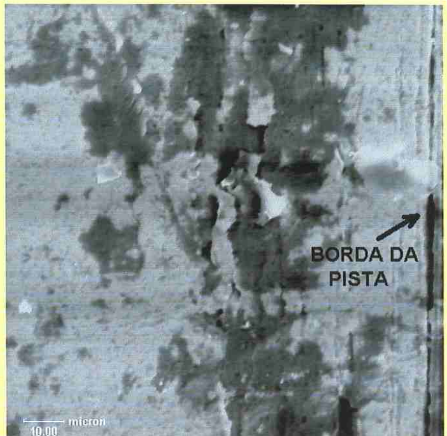
Figura 358. Foto de microscopia eletrônica de varredura do meio da pista do disco movido, após o ensaio ER82, evidenciando zonas escuras (“ dark etching region ”) da matriz de aço AISI 52100 SBQT, possivelmente decorrentes da sobrecarga devido à expulsão de partículas (“ debris ”) lamelares da zona de contato para a borda
