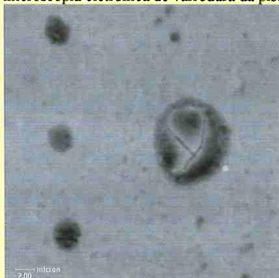
MEIO DA PISTA, GÊNESE DA MALHA DE TRINCA TÉRMICA NO FUNDO DE UM PITE DE \phi 6\mu\text{m}
