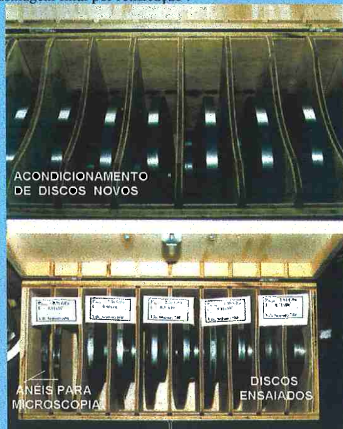
Figura 124. Acondicionamento de discos novos oriundos da manufatura (acima) e após ensaiados (abaixo)
