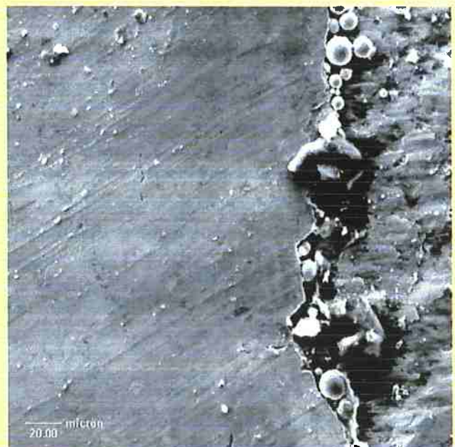
Figura 334. Microtrincas circunferenciais (direção vertical) e axiais (direção horizontal), na pista do disco motor ER84, insinuando movimento axial relativo entre os discos motor e movido –“fretting”
