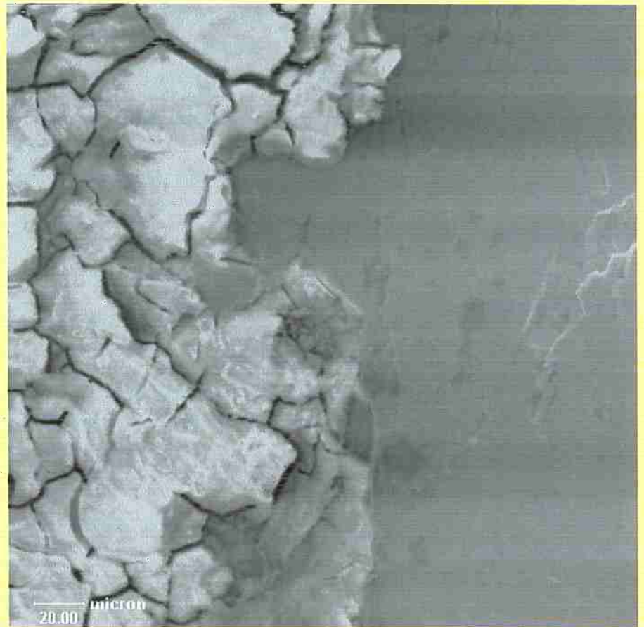
Figura 353. Fotos de microscopia eletrônica de varredura do meio da pista do disco movido, após o ensaio ER82, evidenciando transição de comportamento frágil-dúctil da matriz de aço AISI 52100 OQT, em que zonas plasticamente deformadas e em processo de delaminação coexistem ao lado de malha de microtrincas
