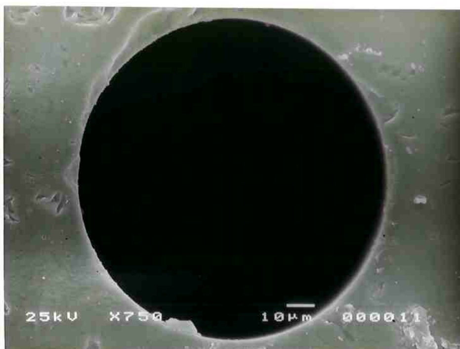
Figura 6.1.8 Microorifício de rubi D113L02.2 ( D = 112,6 \mu\text{m} , L = 254 \mu\text{m} , L/D = 2,2 ). Vista a partir da face de entrada do gás.
