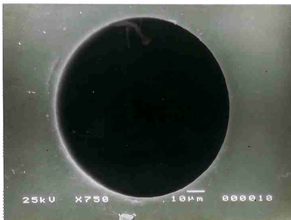
Figura 6.1.9 Microorifício de rubi D100L02.5 ( D = 99,7 \mu\text{m} , L = 254 \mu\text{m} , L/D = 2,5 ). Vista a partir da face de entrada do gás.
