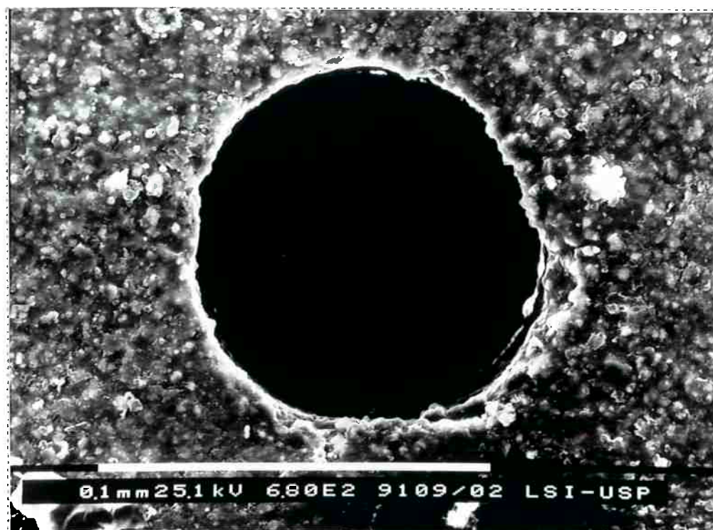
Figura 6.2.7. Fotografia do microorifício de cerâmica verde de diâmetro D 91 \mu\text{m} e relação comprimento pelo diâmetro L/D 8.2 (amostra D091L08.2 ).
