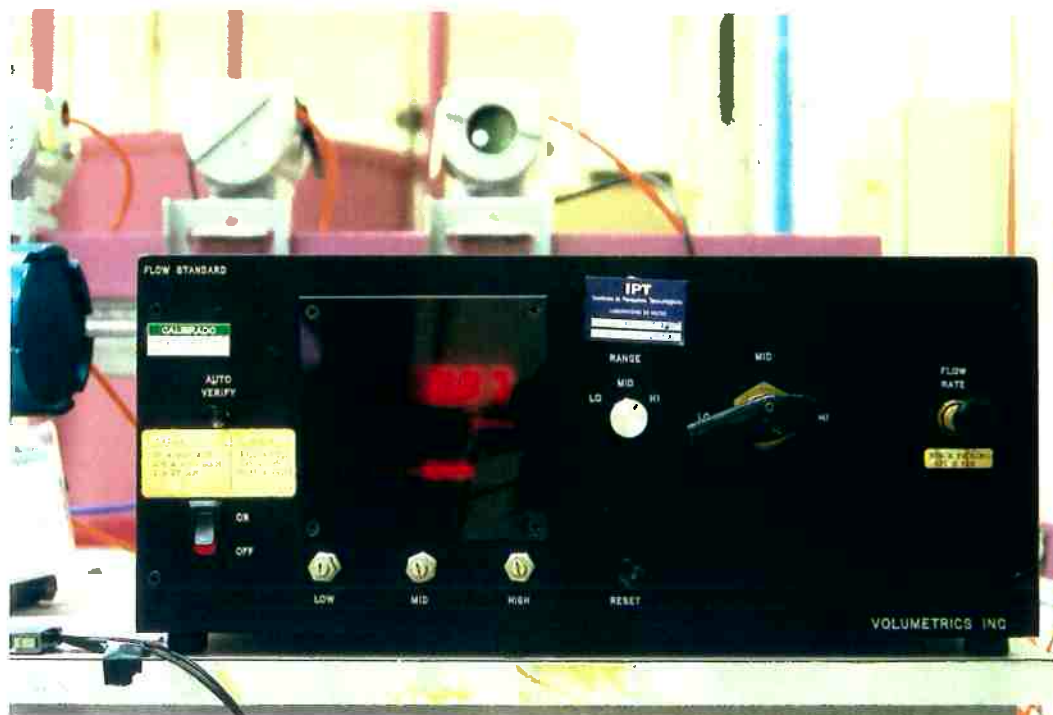
Figura 4.7. Medidor padrão de vazão mássico.
