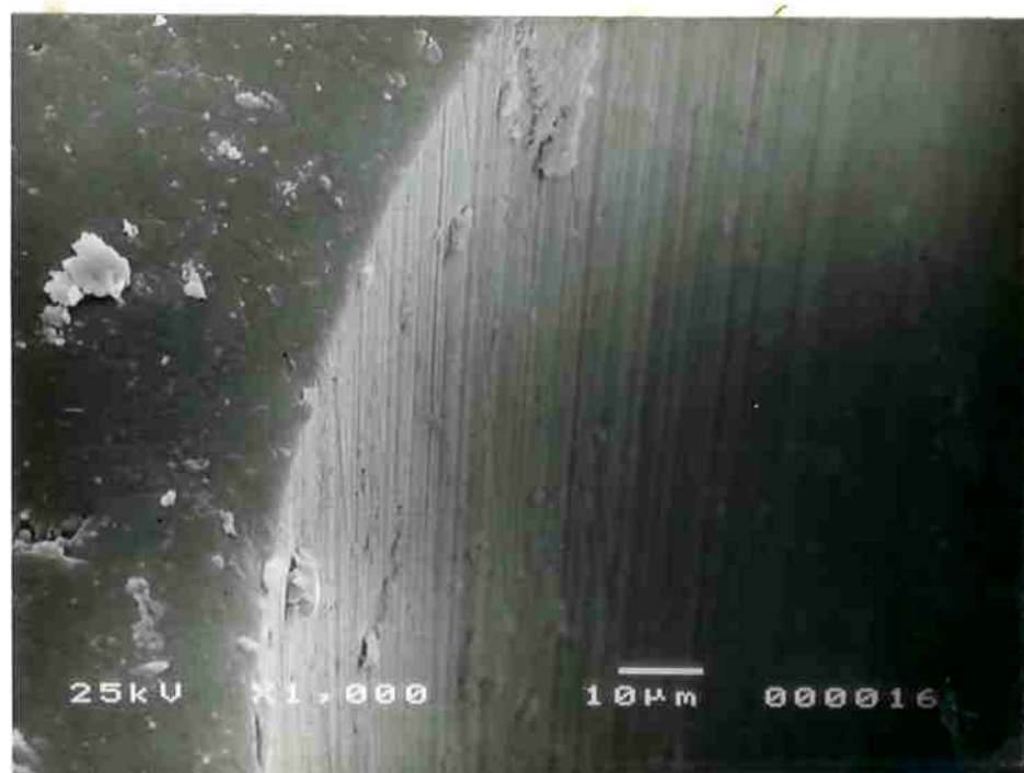
Figura 6.1.3 Microorifício de rubi D423L0.60 ( D = 422,6 \mu\text{m} , L = 254 \mu\text{m} , L/D = 0,60 ). Detalhe da borda de entrada em canto-vivo e da rugosidade da superfície interna.
