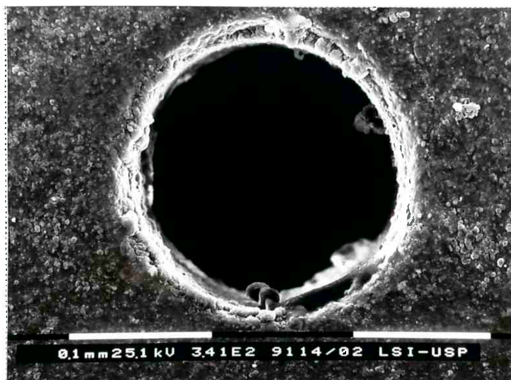
Figura 6.2.5. Fotografia do microorifício de cerâmica verde de diâmetro D 186 \mu\text{m} e relação comprimento pelo diâmetro L/D 4,0 (amostra D186L04.0 ).
