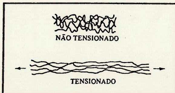
Fig. 3.12: Deformação por elasticidade entrópica (alinhamento molecular) (32)
