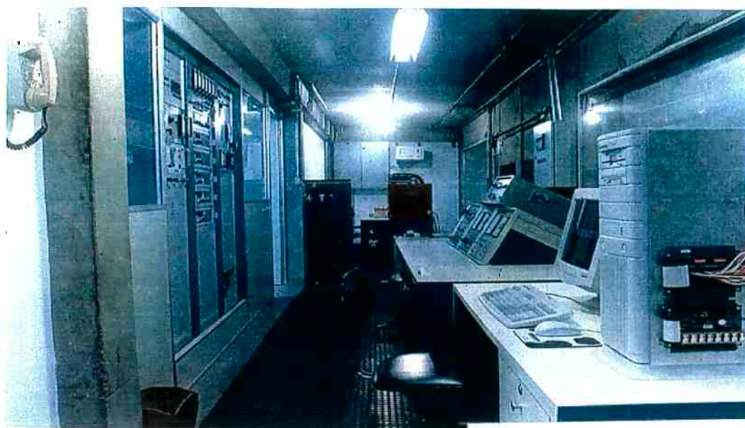
Fig. 4.16 – Sala de controle do dinamômetro, dos equipamentos e instrumentação de ensaio.
