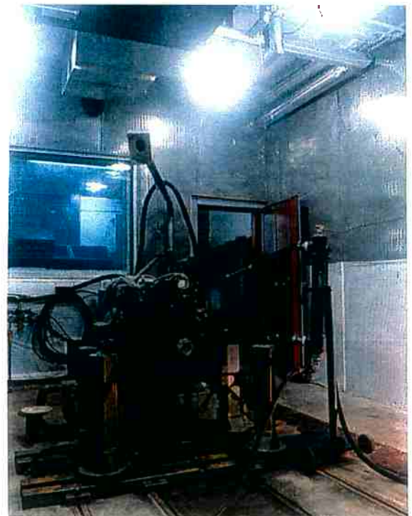
Fig. 4.15 – Sala de dinamômetro com sistema de ar condicionado.
