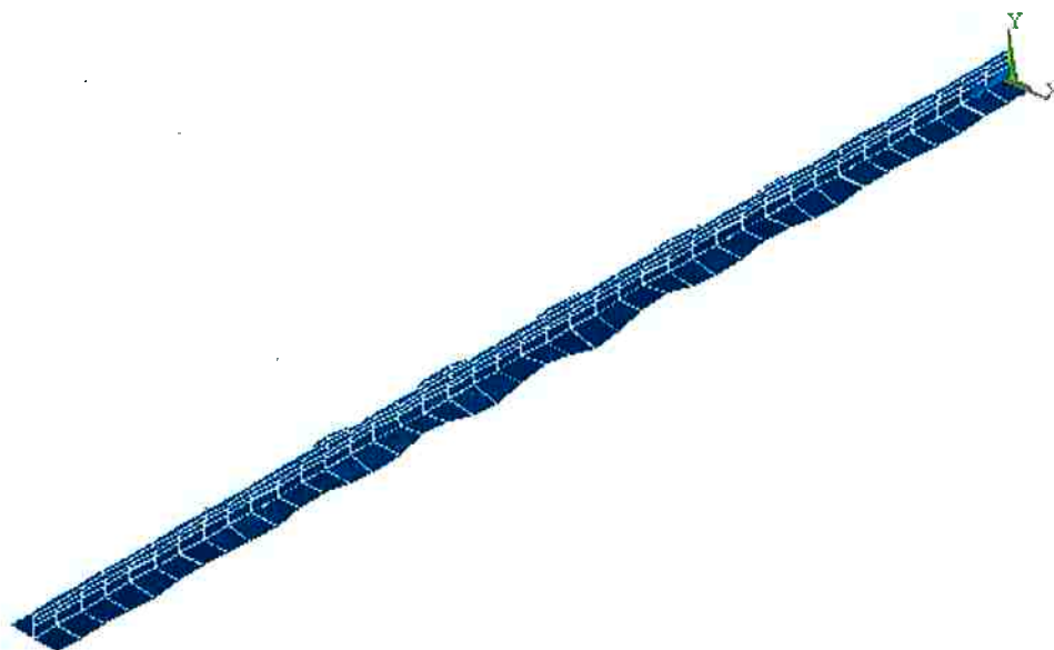
Figura 3.21 Modo local de flambagem no flange inferior
