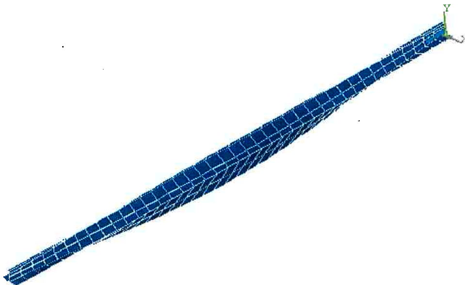
Figura 3.14 Modo de flambagem por flexão-torção
