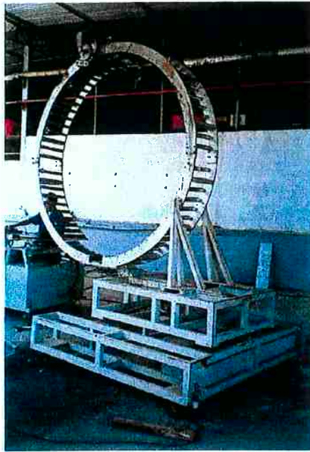
Figura 1.3 Vista geral do anel de enrolamento do tubo
