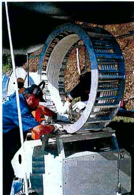
Figura 1.4 Etapa inicial de montagem do perfil no anel de enrolamento do tubo
