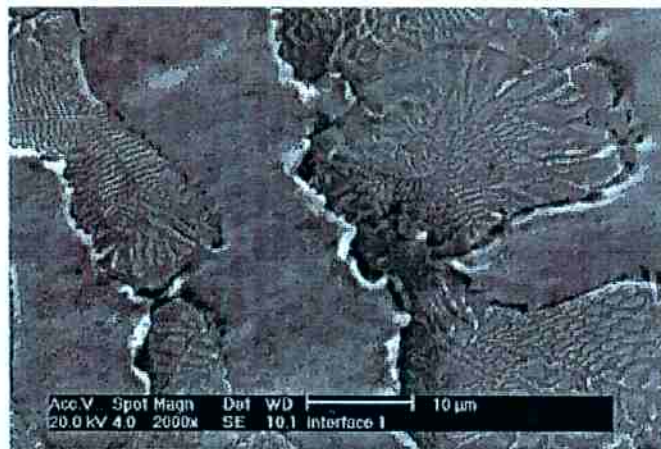
Figura 5.43: Arrancamento de material no contorno de célula eutética da liga 2 após 60 minutos de ensaio (MEV)
