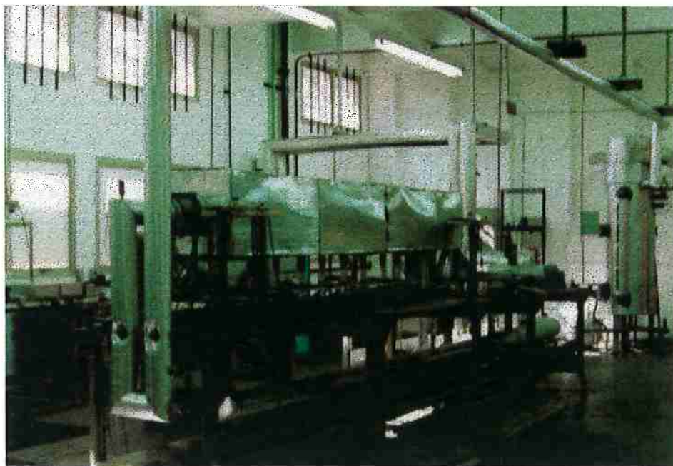
Figura 3.18. Seção de testes montada com isolamento protegido por capa de alumínio corrugado.
