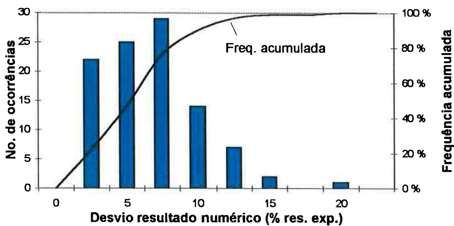
Figura 5.18. Histograma e frequência acumulada do desvio absoluto dos resultados numéricos em relação aos experimentais, considerando a totalidade dos resultados experimentais, para CFC 12, tubo capilar não adiabático.
