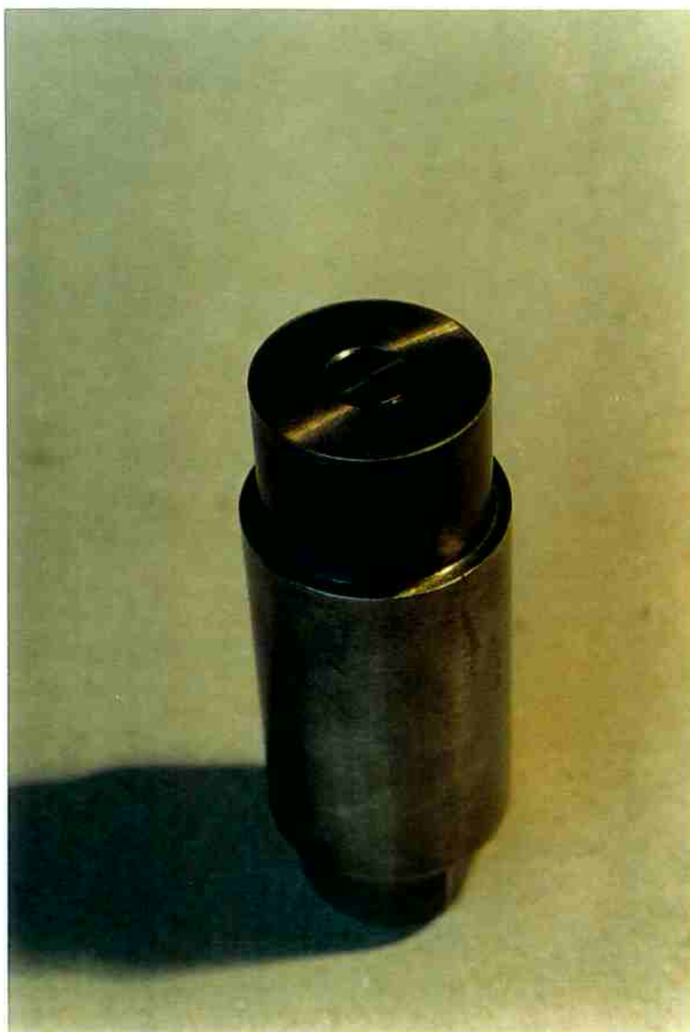
Figura 3.5: Detalhe da válvula dosadora de gás montada.
