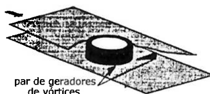
figura 2.17: Disposição dos geradores de vórtices longitudinais - DWP. FIEBIG et al. (1995b).
