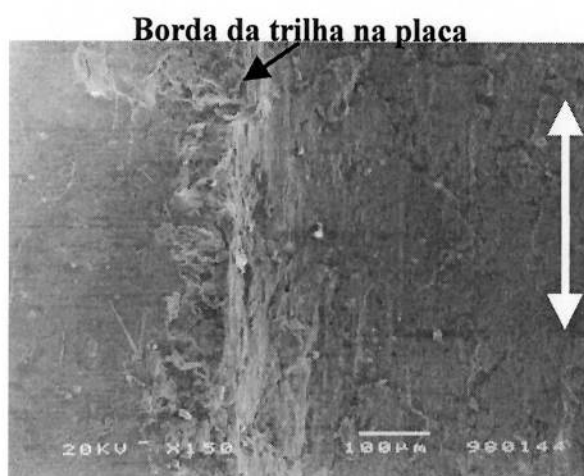
Figura 6- 2: MEV da superfície de desgaste da placa, após ensaio PA24 (100 °C).
