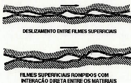
Figura B- 1: Esquema do mecanismo de adesão [8].
