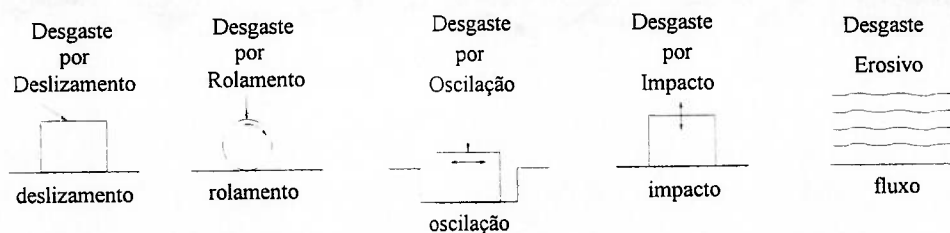
Figura 3- 3: Classificação do desgaste, associado ao movimento [9].
