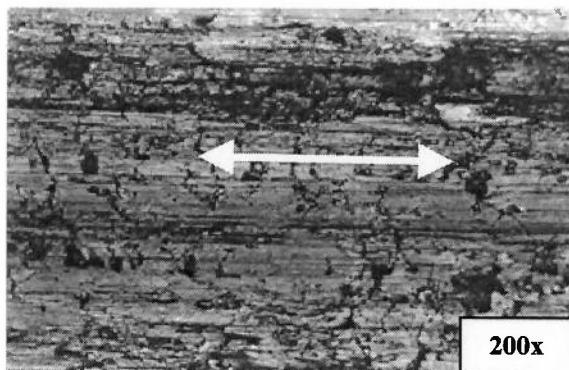
Figura 5- 15: Superfície de desgaste da placa após o ensaio finalizado com transição do desgaste (ensaio P5). 200x.
