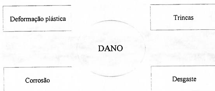
Figura 3- 2: Causas dos danos de superfícies [9].
