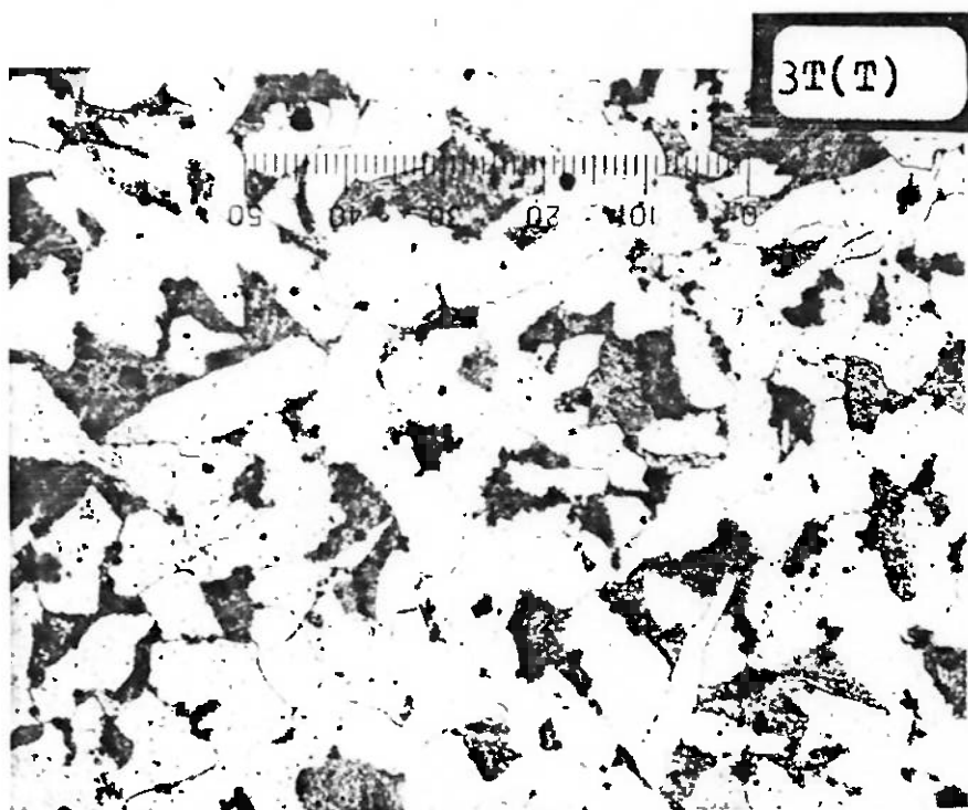
Figura (40) - Aço trefilado ABNT-1020 a 200°C, de \varnothing 24,00 mm com taxa de redução de 20,9%, ampliação 160 X, corpo de prova transversal.
