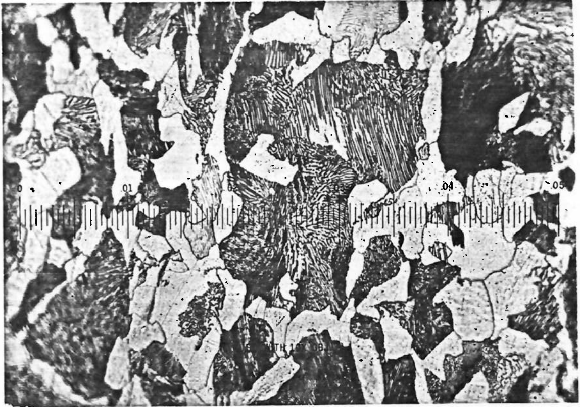
Figura (57) - ABNT-1045 (1.000 X) longitudinal - Trefilado - 400°C.
