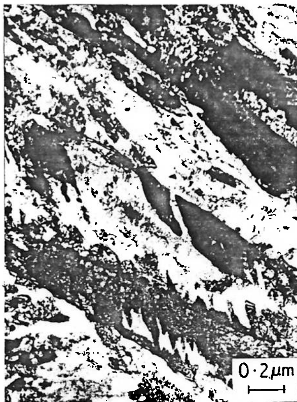
Figura (21) - Microestrutura "Hot-cold-working" (50000 X) aço ligado (0,6% C - 1,4% Si - 0,6% Mn - 0,6% Mo - 0,2% V).
