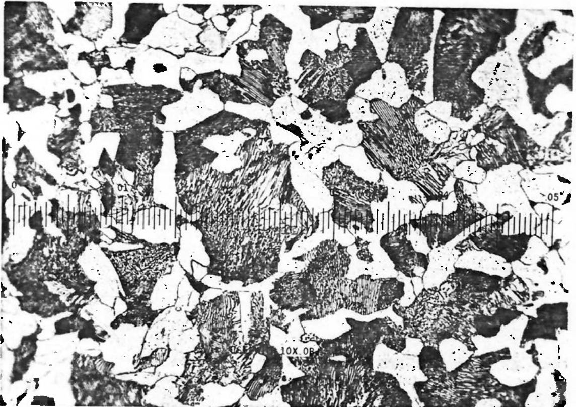
Figura (60) - ABNT-1045 (1.000 X) transversal - Trefilado - 400°C.
