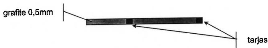
Figura 13. Detalhe da preparação do eletrodo depositante (grafite).
