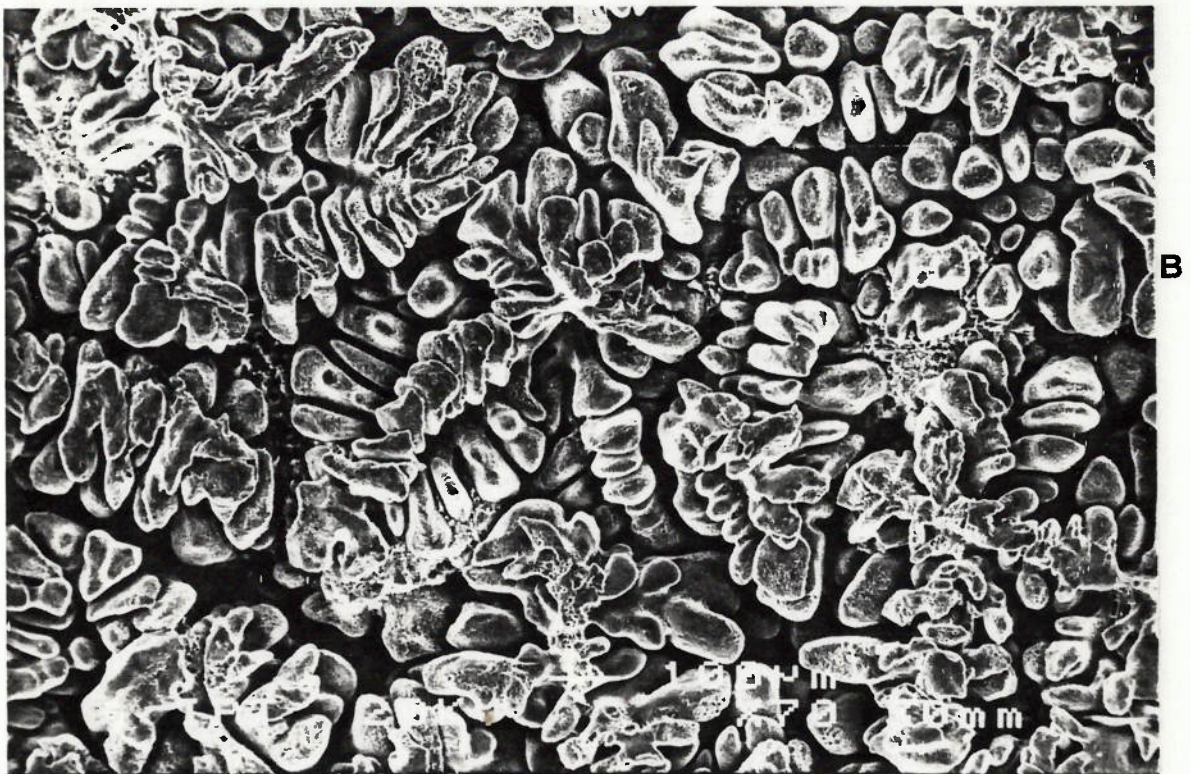
Figura 130 - Microestruturas obtidas em M.E.V., de corpos-de-prova modificados com sódio e congelados a 590 °C (A) e a 575 °C (B), mostrando a rede de dendritas. Ataque NaOH 20%. A- 55x; B- 70x
