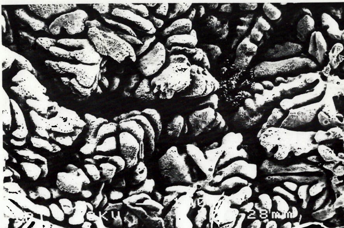
Figura 135.- Microestrutura obtida em M.E.V., de corpos-de-prova modificados com antimônio e congelado a 590°C, mostrando a formação de pequenos braços de dendritas sobre dendritas pró-eutéticas. Ataque NaOH 20%. 70x.
