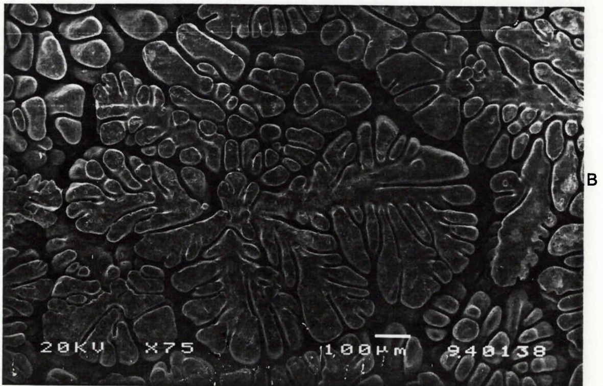
Figura 133 - Microestruturas da região superior de corpo-de-prova modificado com estrôncio e congelado a 575°C mostrando evidências de crescimento competitivo entre braços de dendritas. (A)-75x e (B)-75x.
