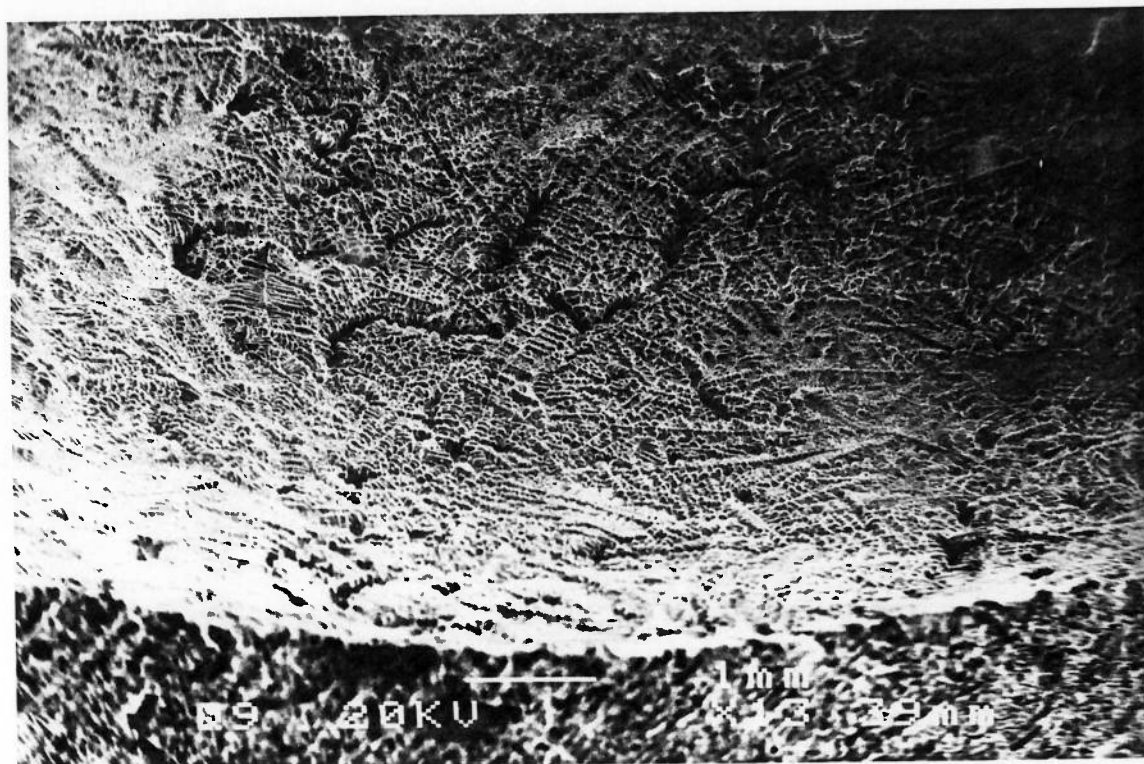
Figura 111 - Aspecto geral do rechupe formado no massalote da barra modificada com estrôncio, observado em M.E.V. Sem ataque. 13x.
