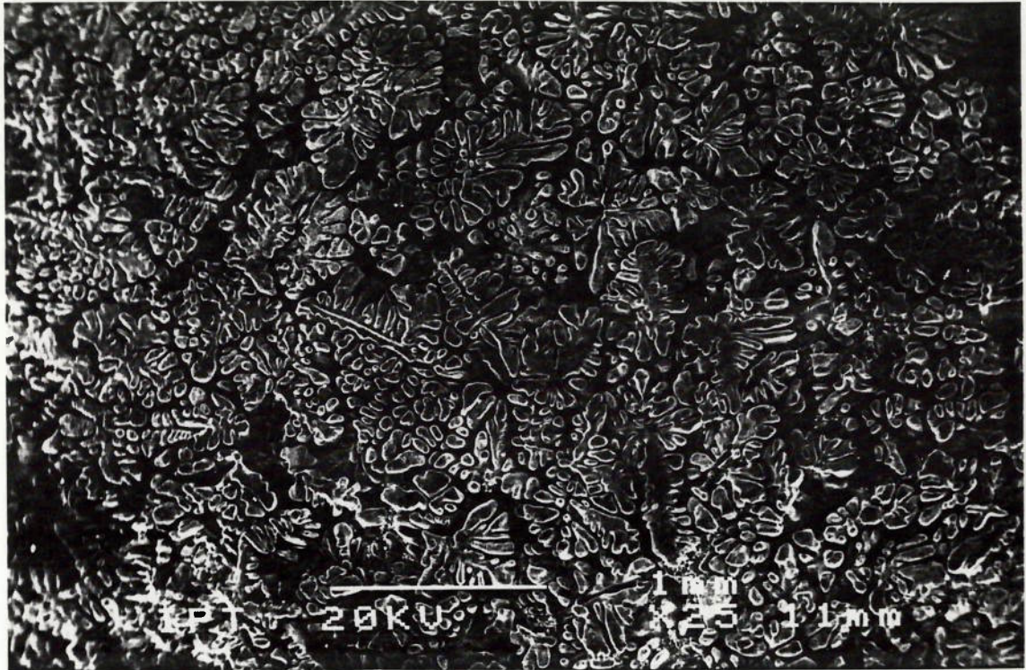
Figura 126 - Micrografia de corpo-de-prova não-modificado, congelado a 575°C, mostrando a morfologia irregular dos grãos ("pinheiro"). Ataque profundo. 25x.
