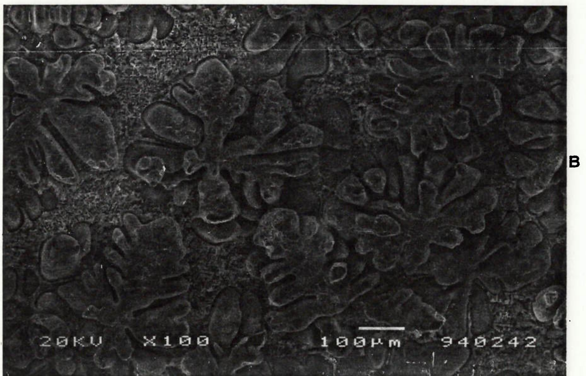
Figura 128 - Microestruturas obtidas em M.E.V., de corpos-de-prova não-modificados e congelados a 590 °C (A) e a 575°C (B), mostrando a rede de dendritas. Ataque NaOH 20%. 100x (A) e 100x (B).
