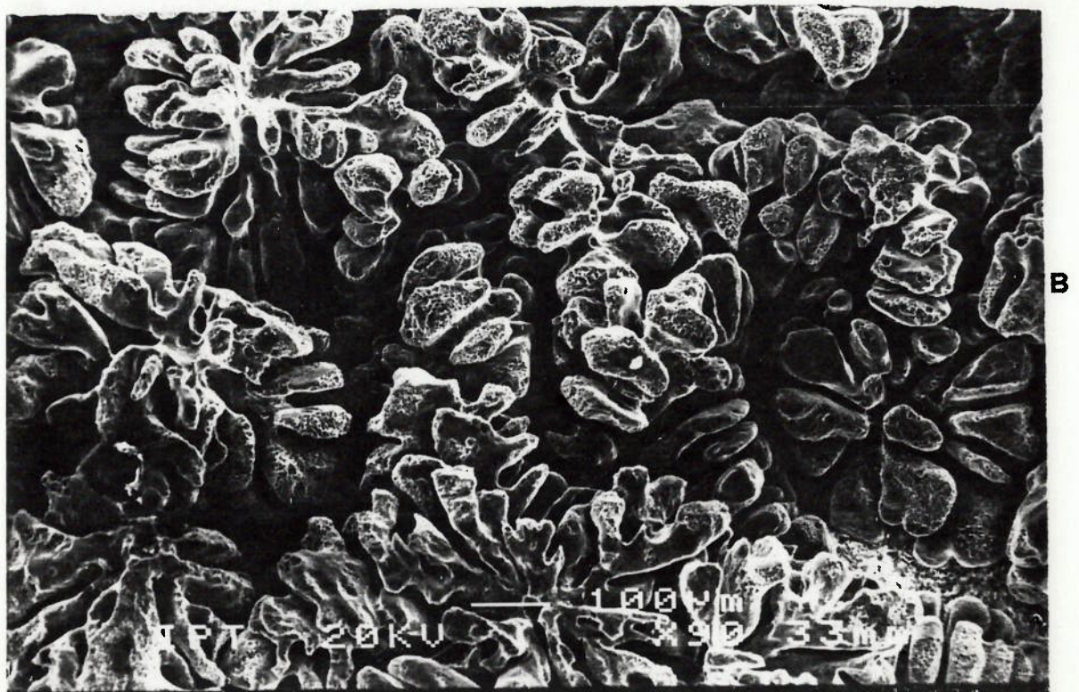
Figura 134.- Microestruturas obtidas em M.E.V., de corpos-de-prova modificados com antimônio e congelados a 590°C (A) e a 575°C (B), mostrando a rede de dendritas. Ataque NaOH 20%. A - 45x; B - 90x.
