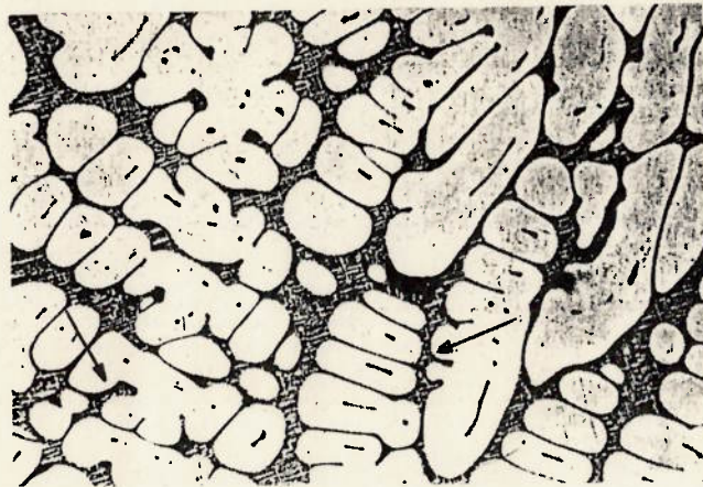
Figura 5- Microestrutura bruta de fundição do aço rápido M2 obtida após “congelamento” durante a transformação peritética L \rightarrow \gamma .
