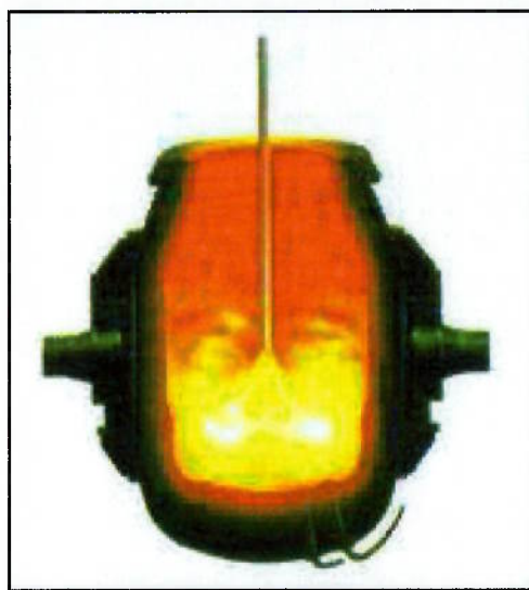
Figura 22 – Desenho esquemático de um convertedor LD com sopro combinado 72
