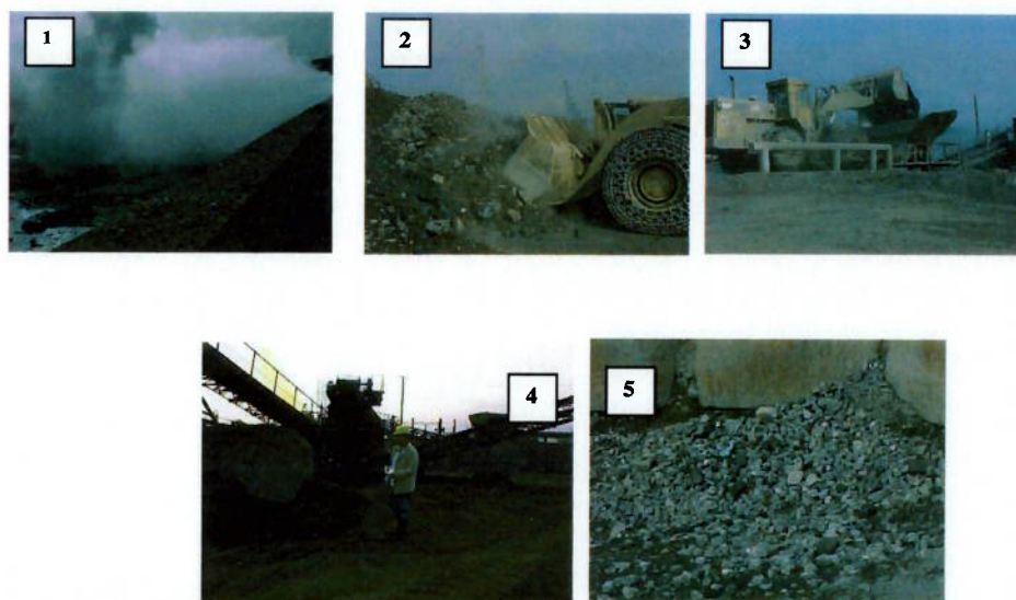
Figura 4 - Sequência do beneficiamento interno de escórias de Aciaria LD (resfriamento com água, transporte, separação magnética e classificação granulométrica)
