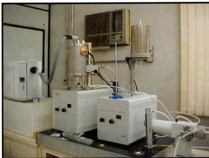
Figura 8. Montagem experimental TG-DTA-MS utilizada.
