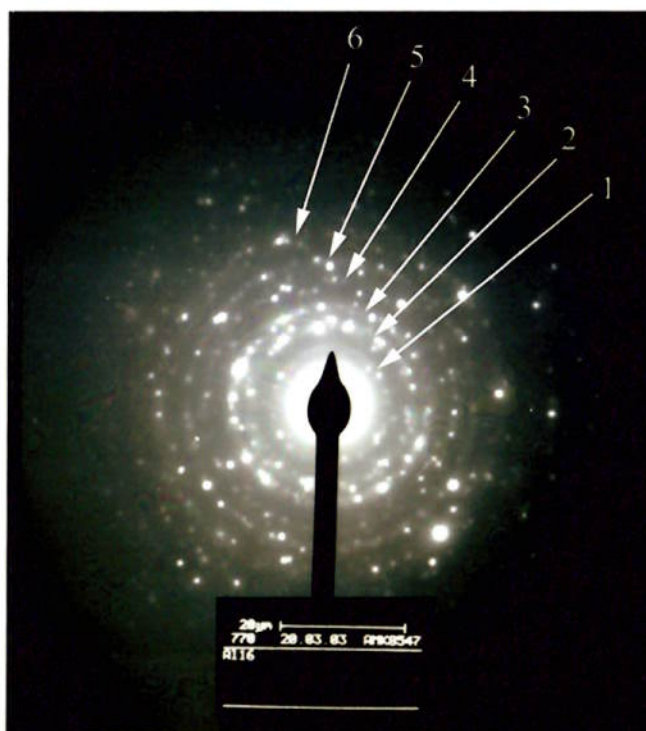
Figura 4. 10 – Padrão de difração de elétrons obtido em uma partícula da mistura de \text{Cr}_2\text{O}_3 + \text{Al} processada por 16 horas determinada por microscopia eletrônica de transmissão.
