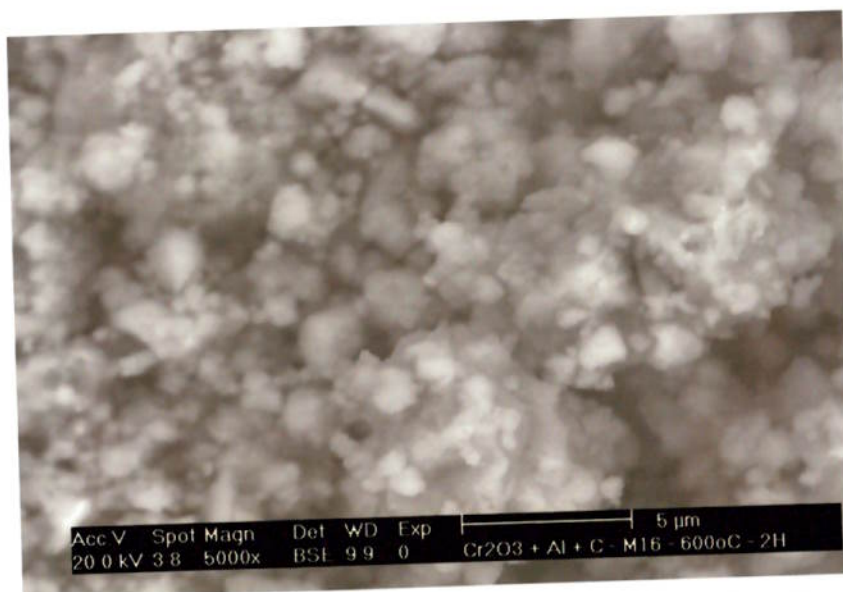
Figura 4. 78 – Imagens obtidas por microscopia eletrônica de varredura, utilizando elétrons retro-espalhados, da mistura 1\text{Cr}_2\text{O}_3 + 2,2\text{Al} + 1,3\text{C} moída por 16 horas e tratada a 600^\circ\text{C} por 2 horas em atmosfera inerte.
