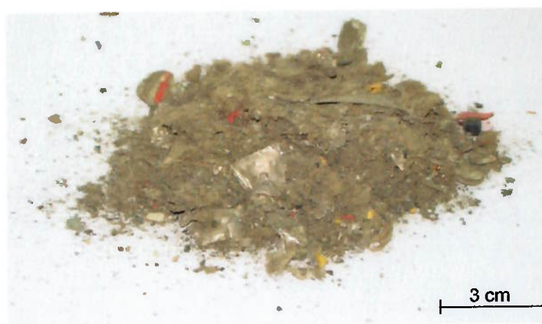
Figura 34 – Material proveniente do procedimento mostrado na Figura 33 e que foi usado nos ensaios de destilação do cádmio.
