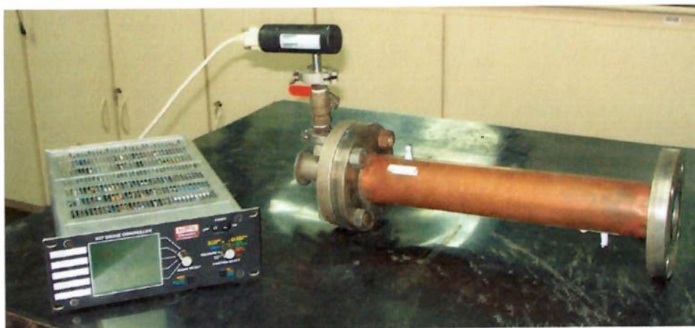
Figura 21 – Detalhe da montagem do medidor de vácuo.
