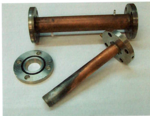
Figura 22 – Condensadores usados nos ensaios com atmosfera de nitrogênio.
