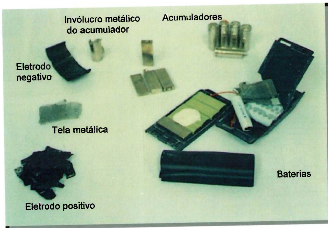
Figura 24 – Principais componentes das baterias de NiCd.
