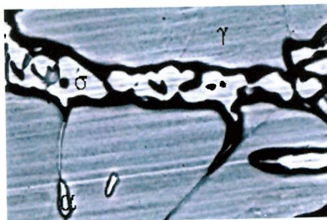
Fig. 3.54 - Imagem de elétrons retroespalhados do aço UNS S31803 tratado a 850°C por 20 h após ensaio na solução B com a técnica EPR-DL. Nota-se um intenso ataque na interface entre a fase sigma e a austenita. MEV. Aumento: 2000X.
