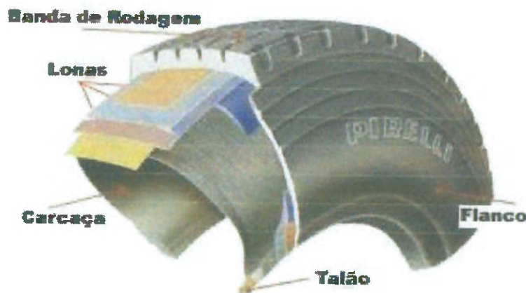
Figura 3 – Estrutura de um pneu radial [21] .
