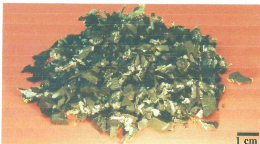
Figura 12 – Fotografia dos pedaços de pneu descartados utilizados nos ensaios de combustão e pirólise.
