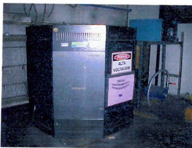
Figura 6: Vista frontal do forno poço para efetuar a sinterização das pelotas de hematita pura.
