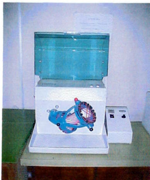
Figura 5: Vista frontal do misturador Turbula utilizado para homogeneização da composição da maioria das pelotas.
