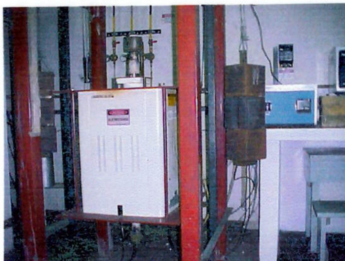
Figura 10: Vista do aparato experimental utilizado nos ensaios termogravimétricos.
