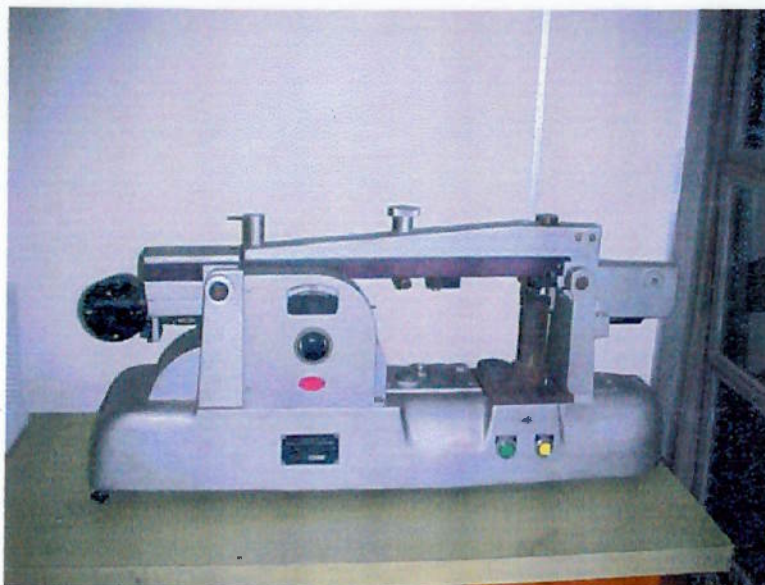
Figura 8: Vista frontal da máquina de ensaio de resistência à compressão Dieter.
