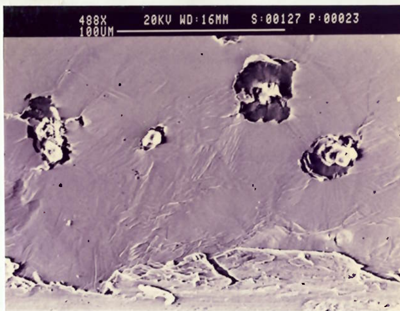
Figura 5-26 Superfícies da região vizinha ao sulco formado em corpos de prova de ferro fundido nodular austemperado a 400°C; dureza 314 HV.
