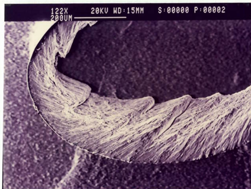
Figura 5-18. Fotografia de MEV de um cavaco obtido no ensaio de resistência ao risco em um aço carbono 1045.
