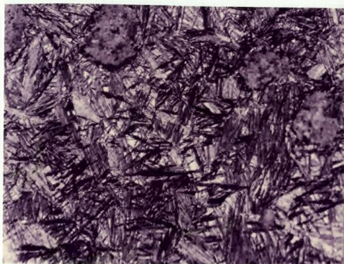
Figura 5-19. Microestruturas do ferro fundido nodular obtidas após tratamento de austêmpera. a) 260°C , b) 280 °C e c) 300° C. Nital 4%. 650X.
