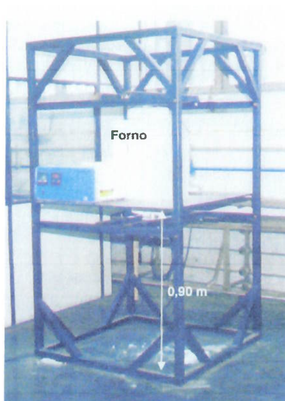
Figura 10 – Aparato experimental utilizado nos ensaios de redução de óxido de cromo em escórias [1]
