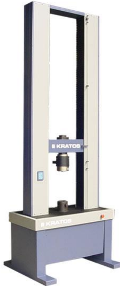
Figura 7 – Equipamento utilizado no ensaio de compressão.
