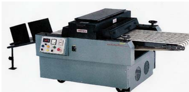
Figura 18 – Túnel UV da marca Germetec (GERMETEC)
