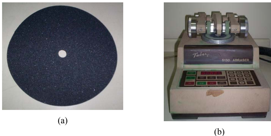
Figura 43 - (a) Disco abrasivo S-11 e (b) calibração dos rebolos utilizando o disco abrasivo S-11
