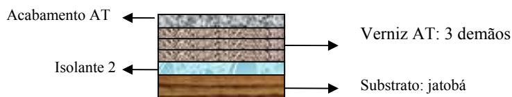
Figura 39 - Processo aplicado para ensaios de resistência ao arrancamento, aderência e resistência à abrasão dos vernizes AT em teste
