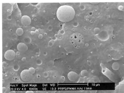
Figura E. 21.- PP/PS/PMMA, 11min, ataque com ácido acético
