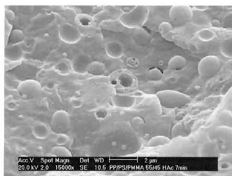
Figura E. 2.- PP/PS/PMMA/PP-g-PS (55/45), 7min, ataque com ácido acético
