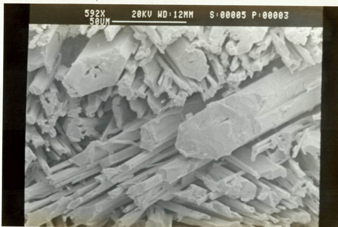
Fig.61(n). Liga E. Ataque profundo para remoção da matriz. MEV.
