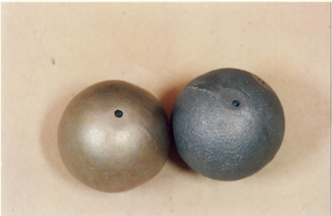
Figura 58a. Aspecto superficial das bolas antes e depois do "run-in".
