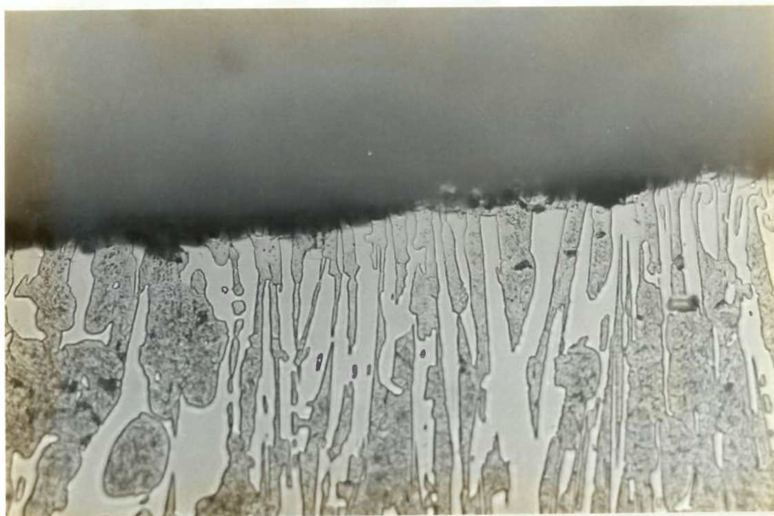
Figura 97. Perfil de desgaste. Liga C, martensítica. Ensaio com Quartzo(1000x).
