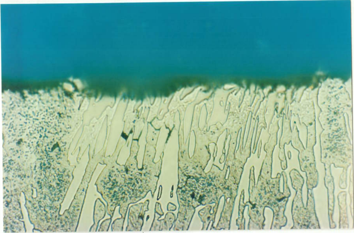
Figura 99. Perfil de desgaste. Liga C bruta de têmpera(1600x).
