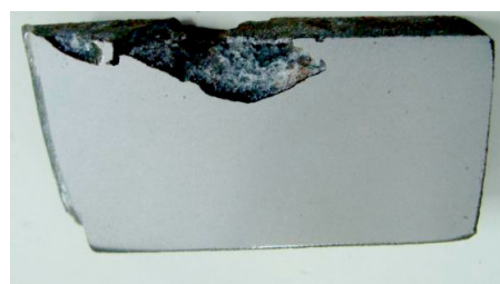
(f) Depressão sem gota de exudação liga 7 – 0,50% Cr + 0,50% Mo 0,2% inoculação
