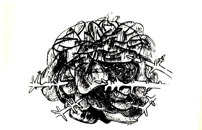
Figura 13. Modelo tridimensional da célula eutética no ferro fundido cinzento (14).
