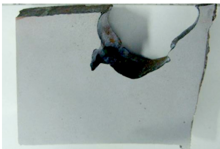
(g) Depressão sem gota de exudação liga 8 – 0,50% Cr + 0,50% Mo 0,6% inoculação
