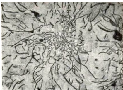
Figura 23. Micrografia de um ferro fundido com grafita lamelar do tipo B. Observada em microscópio ótico. Ataque Nital 4%. Aumento: 100X (06).
