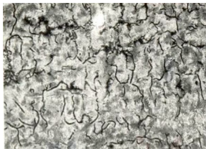
Figura 25. Micrografia de um ferro fundido com grafita lamelar do tipo E. Observada em microscópio ótico. Ataque Nital 4%. Aumento: 100X (06).
