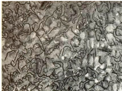
Figura 22. Micrografia de um ferro fundido com grafita lamelar do tipo A. Observada em microscópio ótico. Ataque Nital 4%. Aumento: 100X (06).
