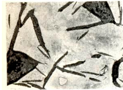
Figura 26. Micrografia de um ferro fundido com grafita lamelar do tipo C. Observada em microscópio ótico. Ataque Nital 4%. Aumento: 100X (06).
