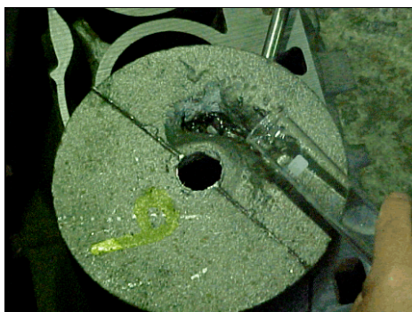
Figura 86. Método de medição do volume das depressões nos corpos de prova fundidos.
