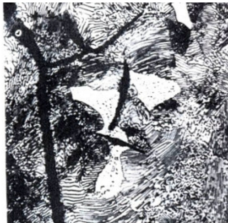
Figura 66. Fosfeto eutético em ferro fundido sem adição de elementos de liga - steadita. Ataque Picral 4%. Aumento 1500x (49).
