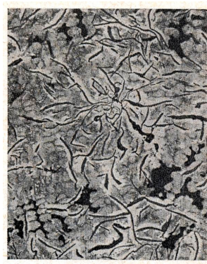
Figura 45. Microrechupe em ferro fundido cinzento (31).
