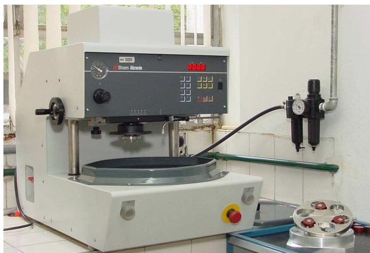
Figura 4.4.1: Politriz automática utilizada para os procedimentos de lixamento e polimento dos corpos-de-prova empregados para caracterização microestrutural. Equipamento do CDMatM-FEI.
