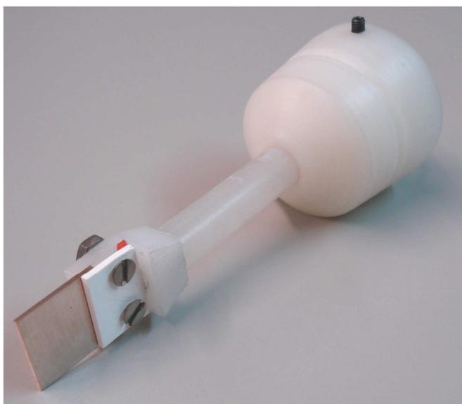
Figura A.1: Porta amostra utilizado para os ensaios de corrosão-erosão em água destilada.
