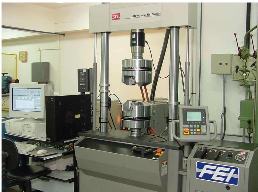
Figura 4.4.3: Máquina universal de ensaios MTS utilizada para os ensaios de tração. (equipamento do CDMatM-FEI).
