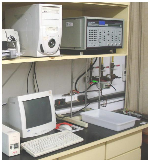
Figura 4.4.5: Vista do equipamento utilizado para a realização dos ensaios eletroquímicos (LPE/PMT).
