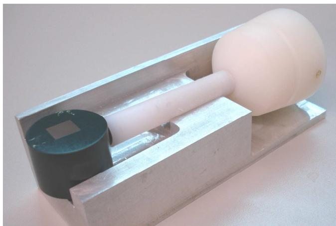
Figura 4.4.12: Porta-amostra utilizado para os ensaios de corrosão-erosão e dispositivo utilizado para manter o paralelismo entre a face da amostra e o pino guia que posiciona a amostra no dispositivo apresentado na Fig. 4.4.11.
