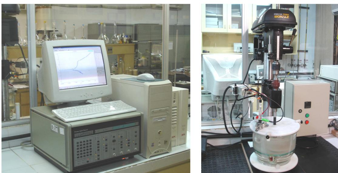
Figura 4.4.7: Vista do equipamento utilizado para a realização dos ensaios de corrosão-erosão (LPE/PMT).
