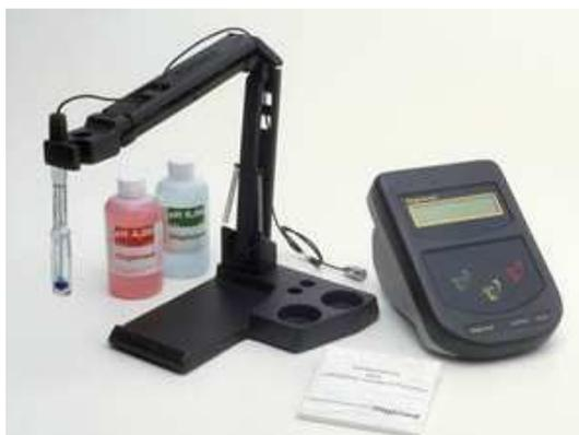
Figura 4.4.4: Aspecto do pHmetro de bancada DIGIMED, modelo DM-21 (equipamento do LPE/PMT).
