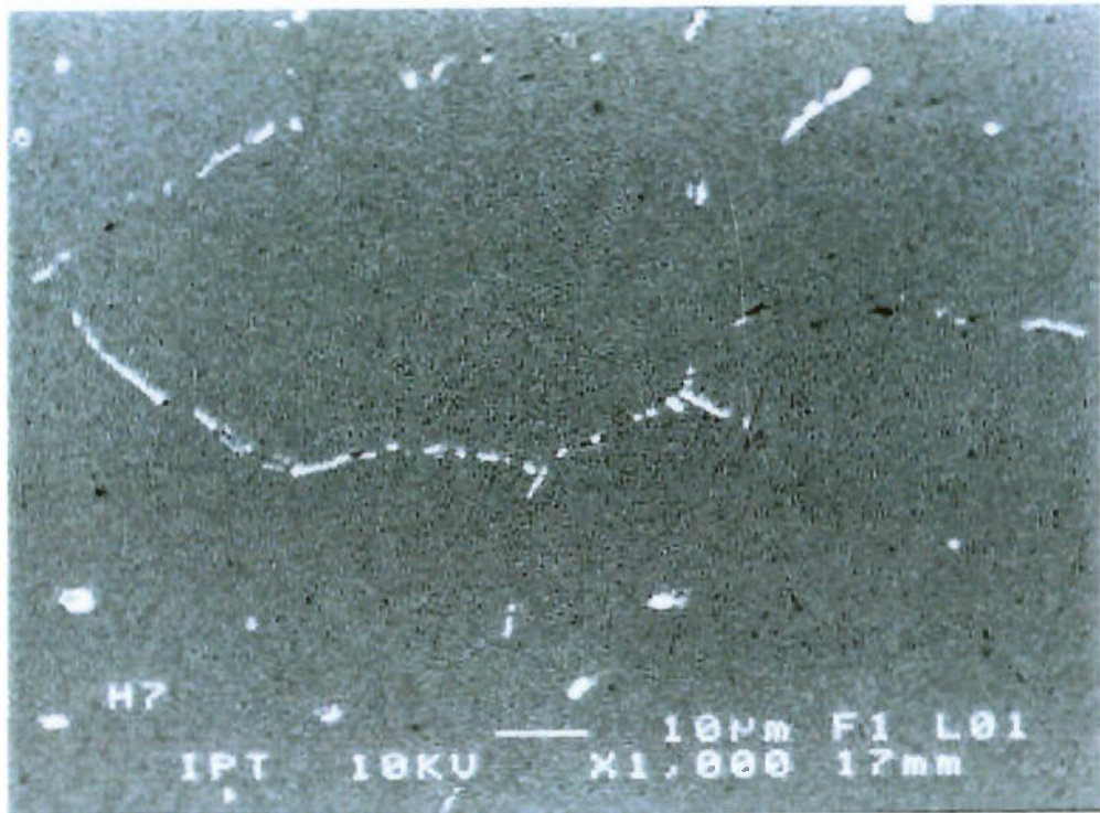
Figuras IV.45 – Al 6063 - SC; homogeneização a 585°C por 2 horas, resfriamento ao ar até 350°C permanência por 1 hora e resfriamento ao ar; MEV.
