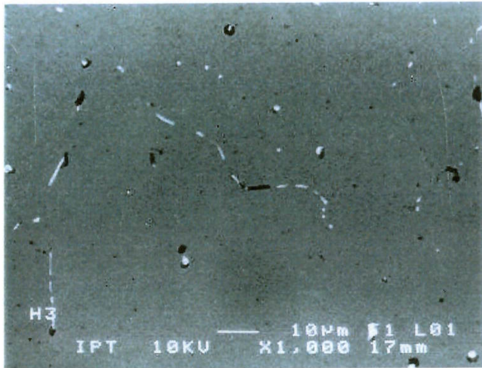
Figura IV.30 – Al 6063 - 2F; homogeneização a 585°C por 2 horas, resfriamento no forno; MEV.
