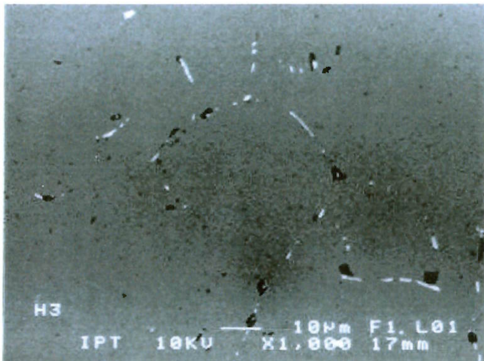
Figura IV.29 – Al 6063 - 2F; homogeneização a 585°C por 2 horas, resfriamento no forno; MEV.
