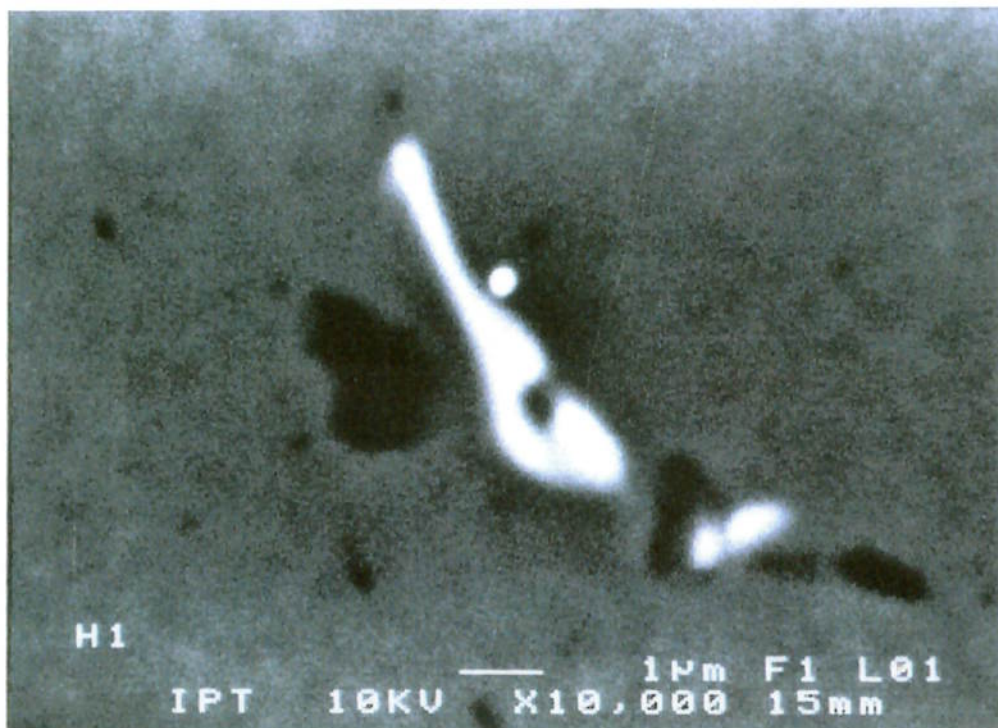
Figuras IV.24 – Al 6063; precipitado presente na amostra da condição 2A de homogeneização; MEV.
