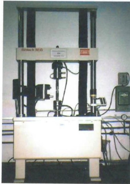
Figura III.3 – Máquina MTS Sintech 30/D - equipamento utilizado nos ensaios de tração da série IPT.
