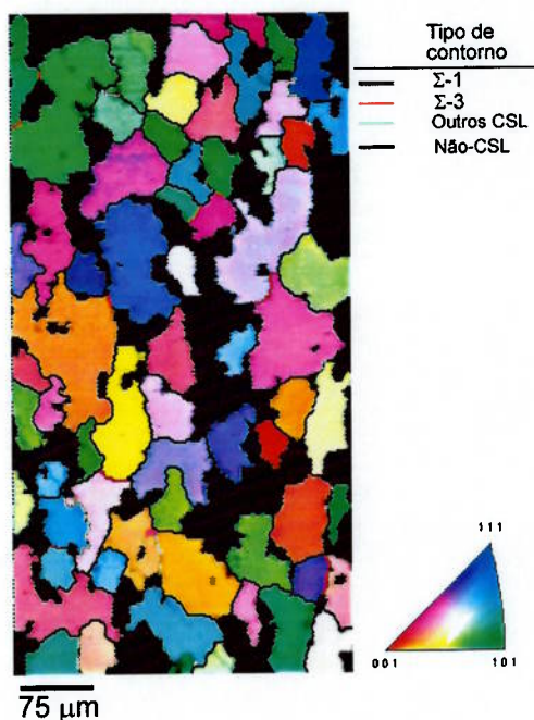
(a) Distribuição de tipos de contornos de grão e figura de pólo inversa dos grãos de ferrita
