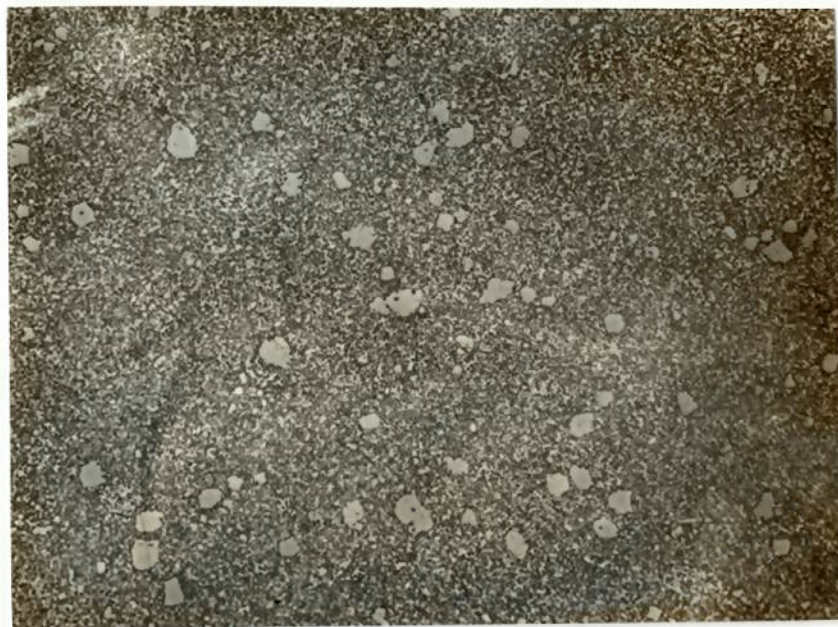
Figura 17 - Microestrutura característica do aço 1,1C-3W-3Mo-2V-2Nb(Ti). Observa-se o tamanho e a distribuição dos carbonetos primários em seção transversal. Ataque: Nital 2%. Aumento: 400X
