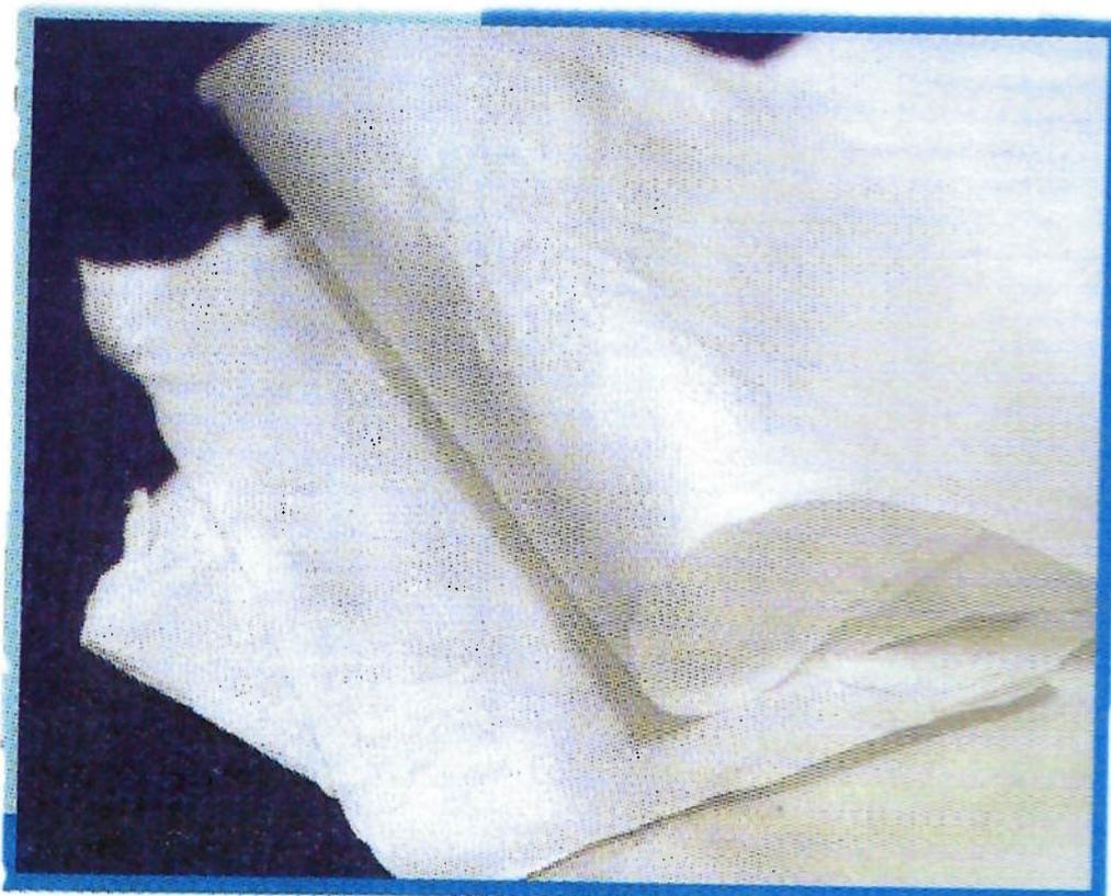
**Figura 39** –Foto de membranas resultantes da solução de 25%PSf Udel® P-1700/NMP obtidas em um banho de coagulação a 60 °C.<sup>4</sup>
