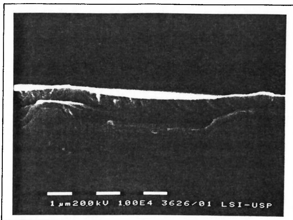
Fig..3.16: Fotografia SEM do corte transversal de uma mostra do tipo Si/SiO 2 /Al/SOG B/Al.
