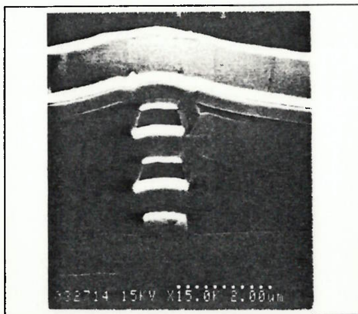
Fig.1.11: Foto SEM da secção transversal de uma lâmina com processo MOS planarizado de 3 níveis metálicos. [95]
