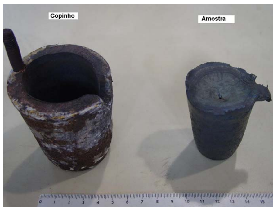
Figura 37: Detalhe do copinho e amostra
