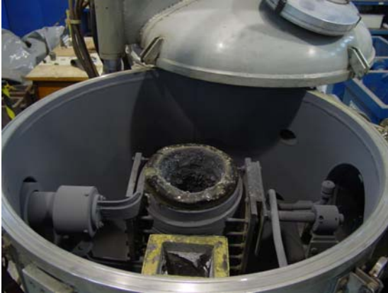
Figura 44: Interior do VIM após fusão da liga VAT 32 contendo Pb.
