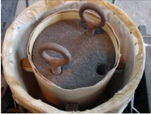
Figura 29: Centralização do cadinho de Grafita
