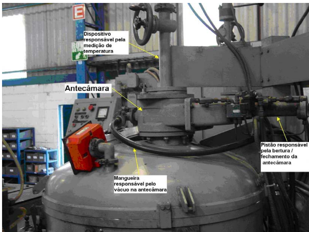
Figura 36: Dispositivo responsável pela adição de carga, medição de temperatura e amostragem
