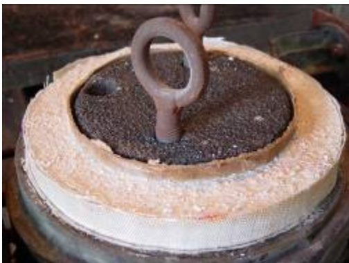
Figura 30: Refratário compactado entre a parede da bobina e a grafita
