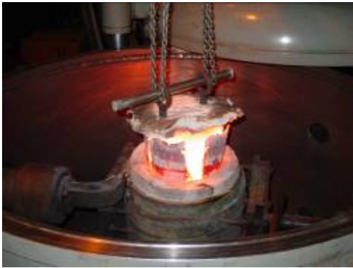
Figura 32: Remoção da Grafita
