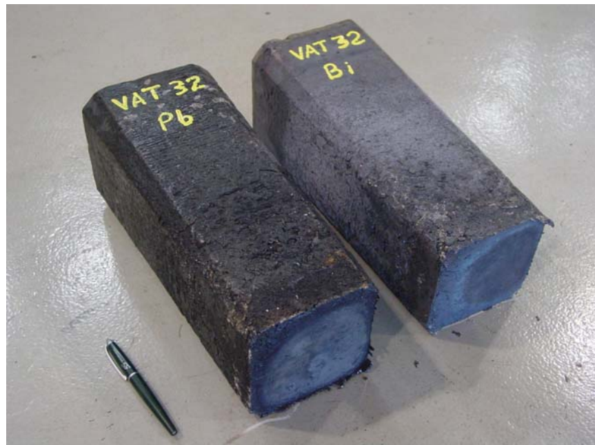
Figura 43: Lingotes (liga mãe) de VAT32 Pb e VAT32 Bi
