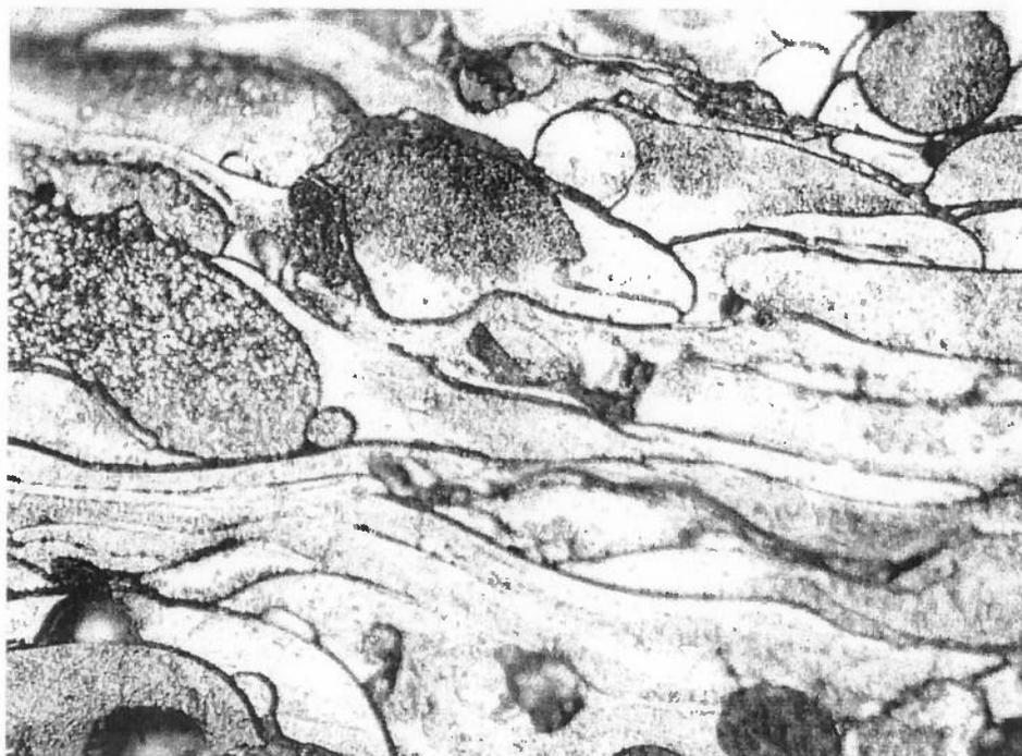
**Figura 34** - Microestrutura do depósito realizado a chama, com aceleração e sem fusão. (Aumento 500 X – ataque eletrolítico com ácido oxálico)
