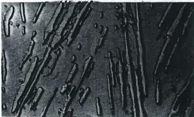
Fig.40 Solubilização a 576°C por 40s da estrutura do revenido. A fase  $\beta$  tornou-se fase matriz, contínua. Plaquetas de fase  $\alpha$  e alguns glóbulos residuais de  $\gamma_2$  entre plaquetas. Ataque eletrolítico.
