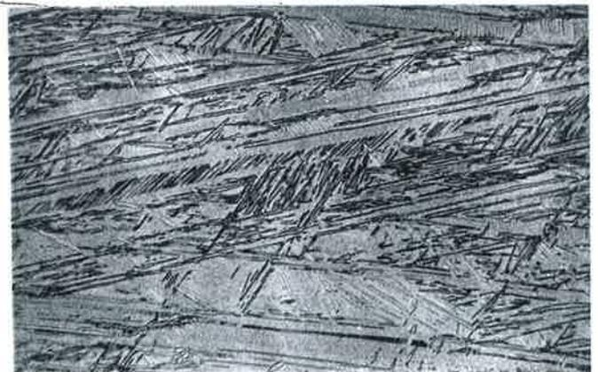
A fase  $\alpha$  tem frequentemente a forma de lâminas ou placas paralelas aos contornos das antigas plaquetas de martensita, com interfaces retas (Fig.16); e pode apresentar-se também na forma de conjuntos de plaquetas retangulares, paralelas entre si, delineando a antiga plaqueta de martensita da qual fizeram parte (Fig.17); algumas plaquetas de fase  $\alpha$  revelam ainda antigos cruzamentos entre plaquetas de martensita (Fig.17).
