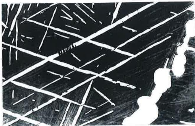
Fig.34 Decomposição da martensita a  $650^{\circ}\text{C}$  por 18 h. Alotriomorfos grosseiros de  $\alpha$ , luz polarizada com Nicóis parcialmente cruzados revelam plaquetas de martensita na matriz, paralelas às plaquetas de  $\alpha$ . Ataque eletrolítico. Aumento 200X, ampliação 2,5X
