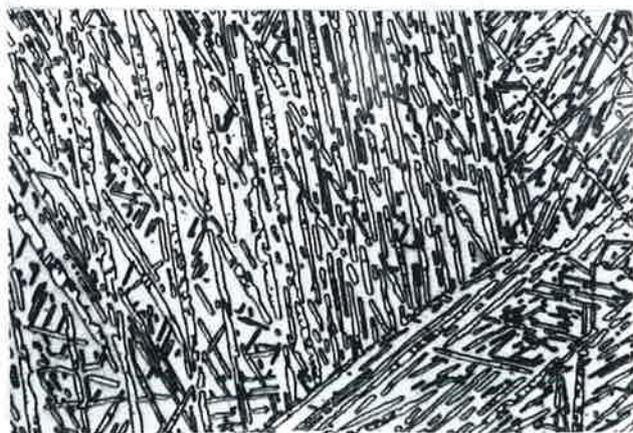
Fig.29 Decomposição da martensita a  $650^{\circ}\text{C}$  por 5s; plaquetas de fase  $\alpha$  da transformação in situ e precipitação de fase  $\alpha$  em contorno de grão.
