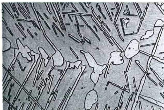
Fig.33 Decomposição da martensita a  $650^{\circ}\text{C}$ , por 18h. Plaquetas grosseiras de  $\alpha$ . Luz polarizada com Nicóis parcialmente cruzados revelam plaquetas de martensita paralelas às plaquetas de  $\alpha$ . Ataque eletrolítico. Aumento de 250X, ampliação 2,5X.
