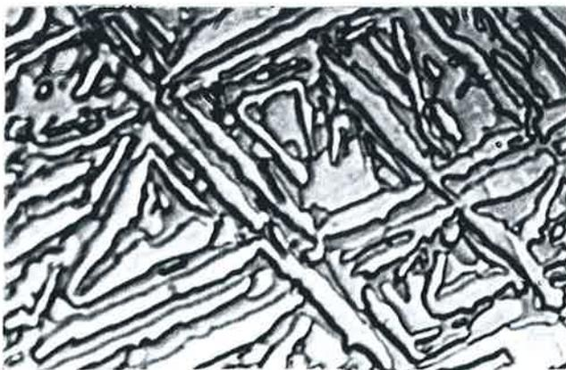
Fig.38 Solubilização a 576°C por 10s da estrutura do revenido. Glóbulos de  $\beta$  no interior de lamelas de  $\gamma_2$ , fase  $\gamma_2$  cinza clara, fase cinza escura, fase  $\alpha$  branca. Ataque eletrolítico. Aumento 500X, ampliação 2,5X.
