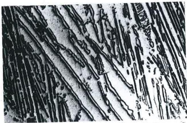
Fig.23 Martensita Revenida a 520°C, 5 min, liga B.
