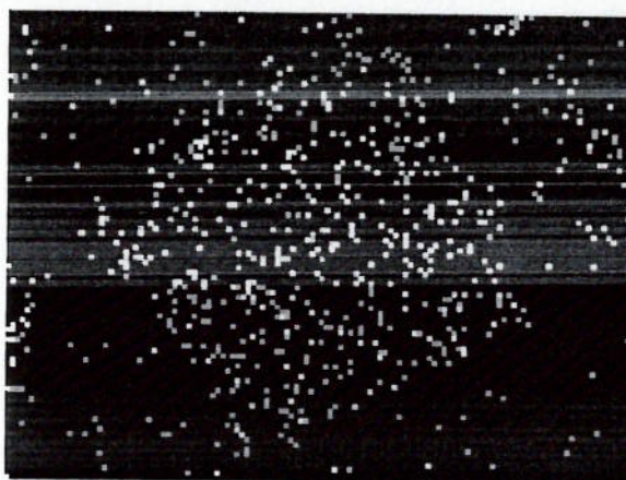
Figura 27 – Mapeamento de enxofre na superfície representada pela imagem da Figura 24
