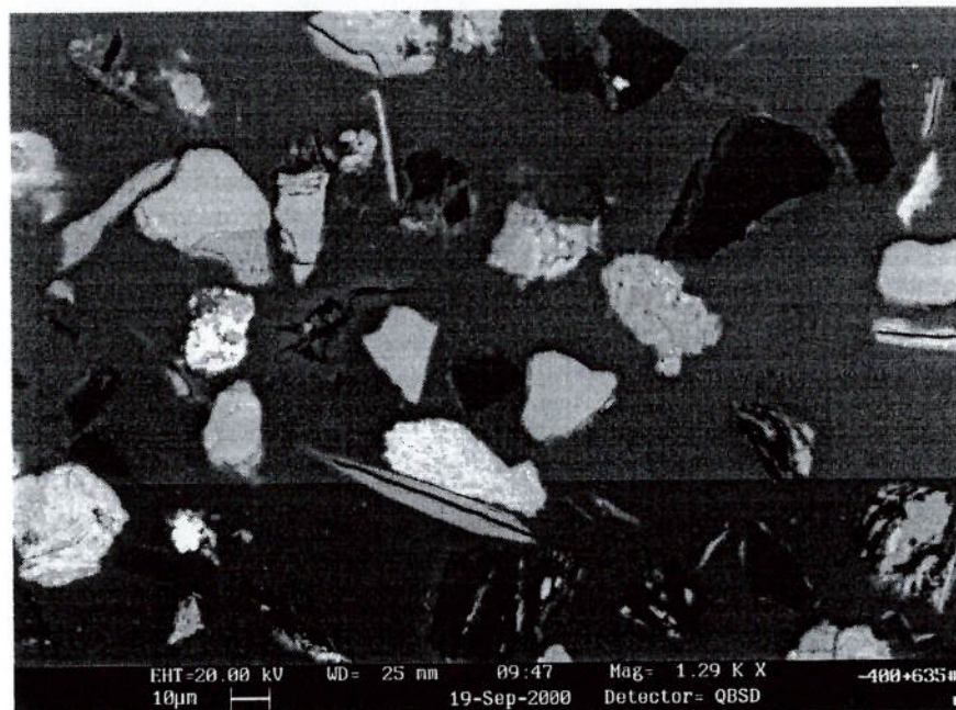
Figura 23 – Imagem (BSD/MEV) de partículas –400 + 635 # contendo carvão (cinza mais escuro), silicatos (cinza médio) e pirita (cinza mais claro/branco) embutidas em resina epoxy.
