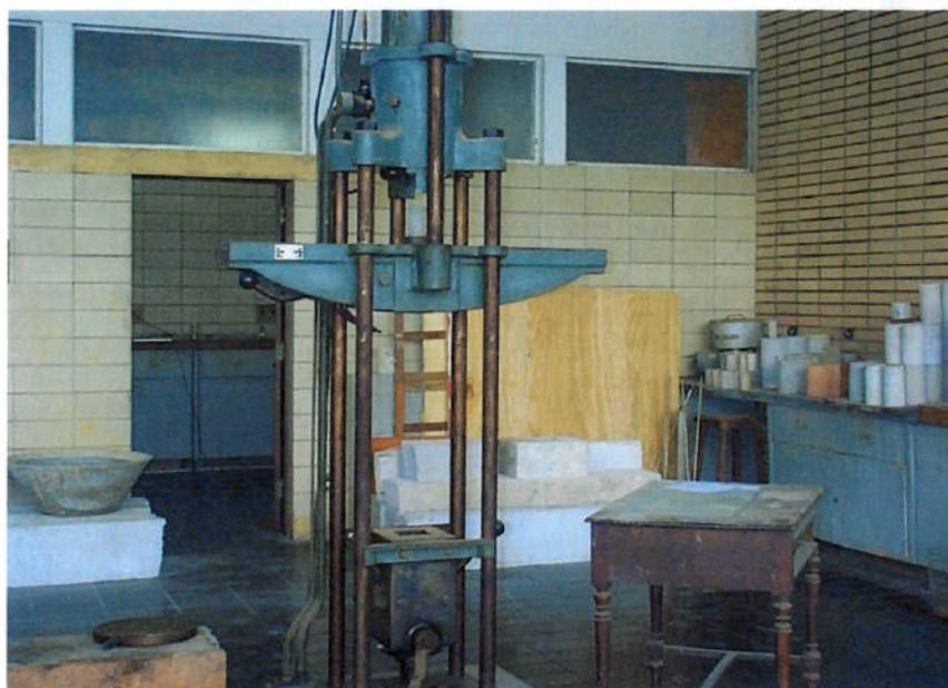
fig. 50 – Equipamento para rompimento dos corpos de prova
