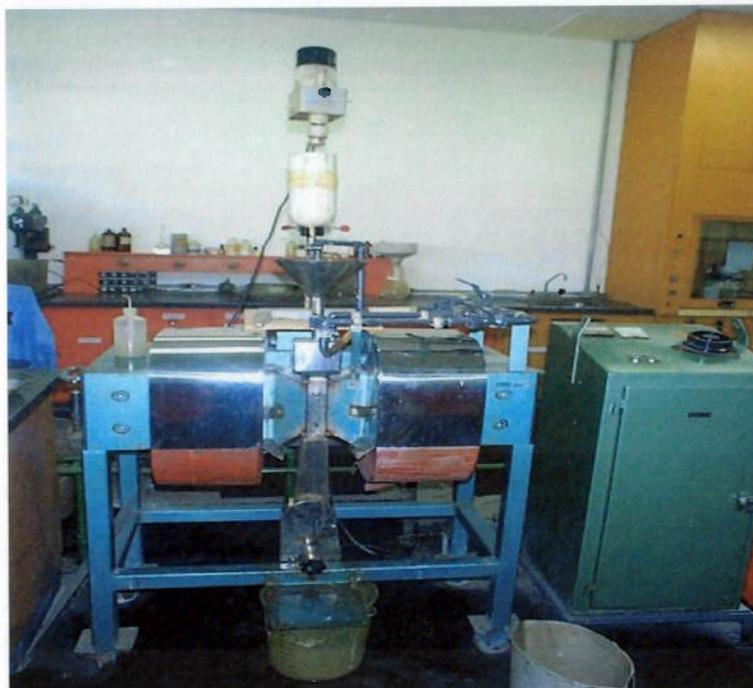
**fig.38 – Separador magnético Boxmag Rapid**
