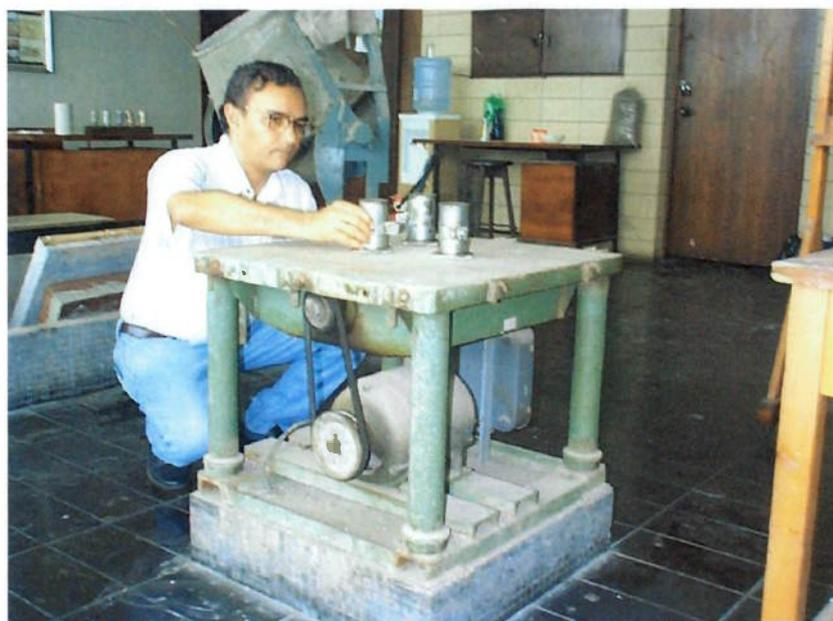
fig 52 – Mesa vibratória para adensamento de argamassas
