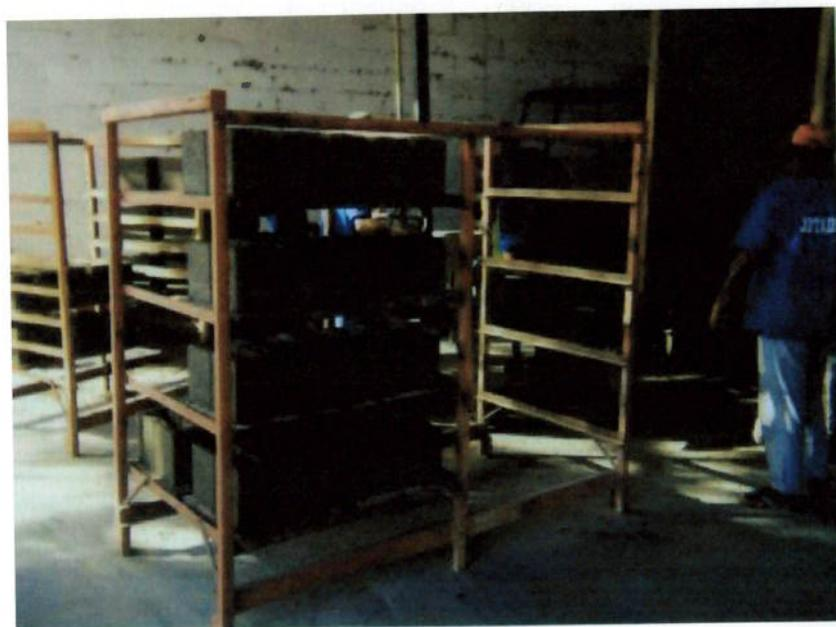
**fig. 60 – Secagem de blocos para aumentar a resistência mecânica**
