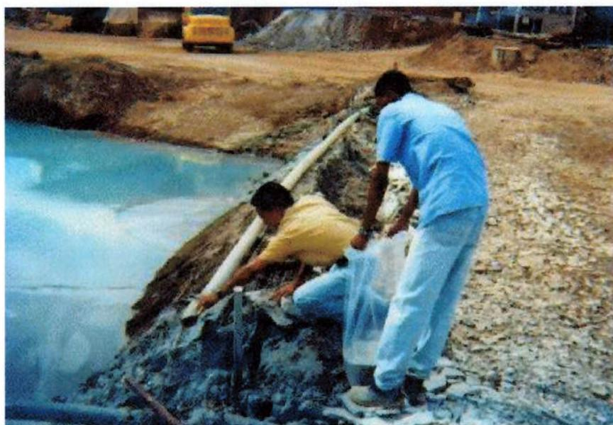
**fig. 32-Coleta no tubo de descarga da lama**
