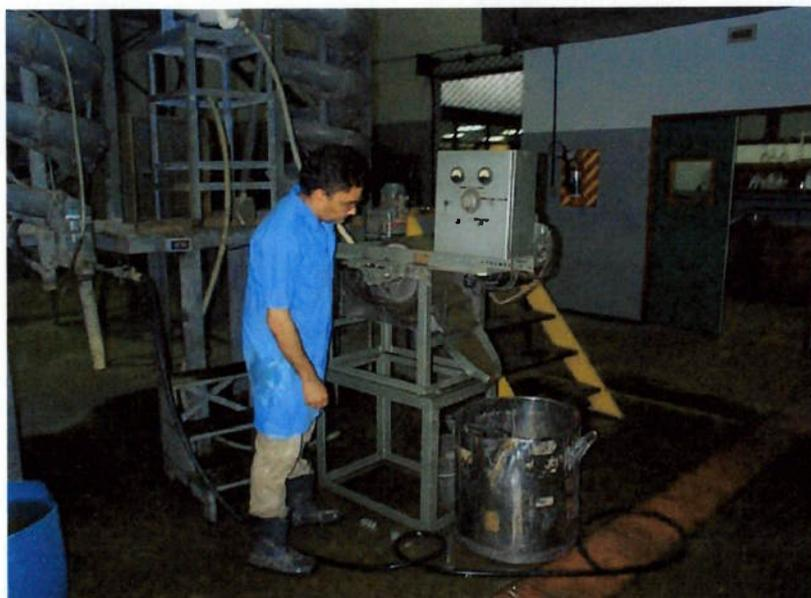
**fig. 39 – Separador magnético de baixa intensidade de tambor**
