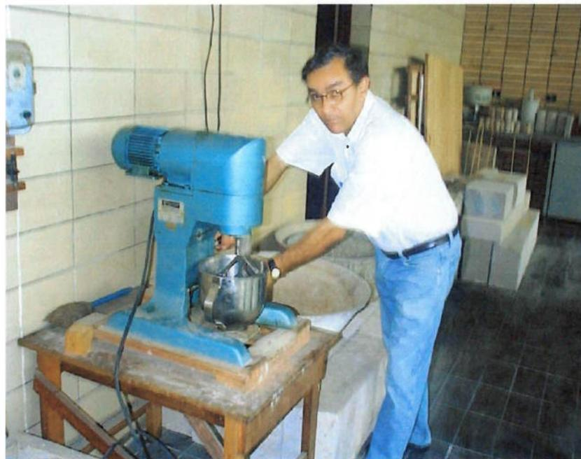
fig. 48 – Argamassadeira usada na preparação da massa
