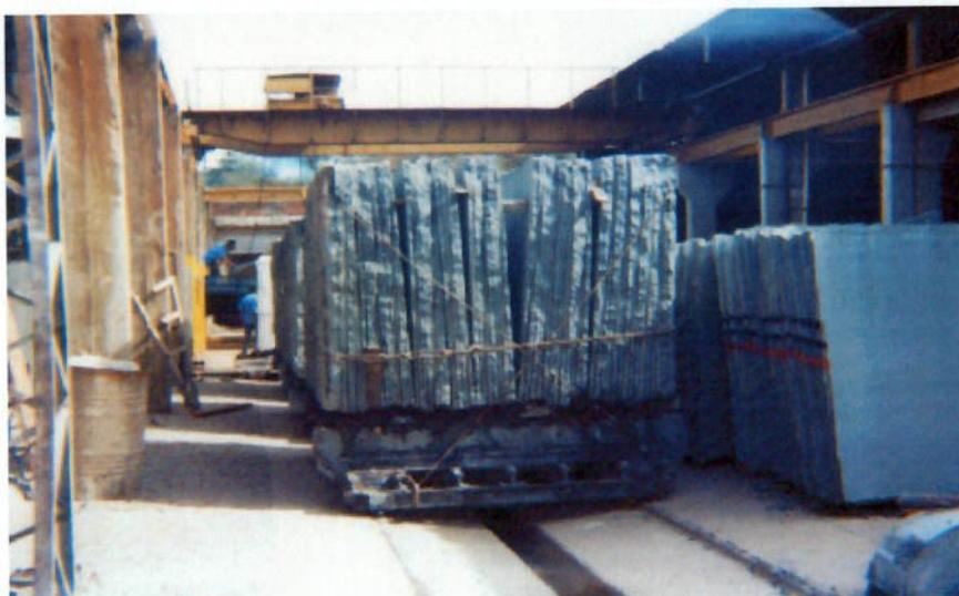
**fig.16 – Placas de granito após desdobraimento**
