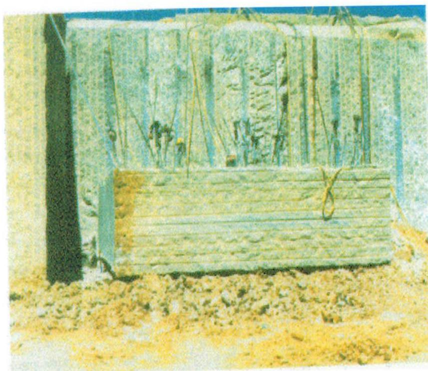
**fig.5 – Corte por perfuração e utilização de explosivo**
