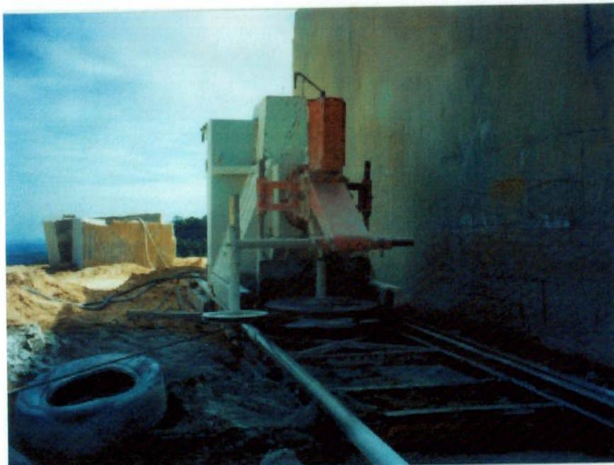
**fig.11–Equipamento para acionamento do fio diamantado**
