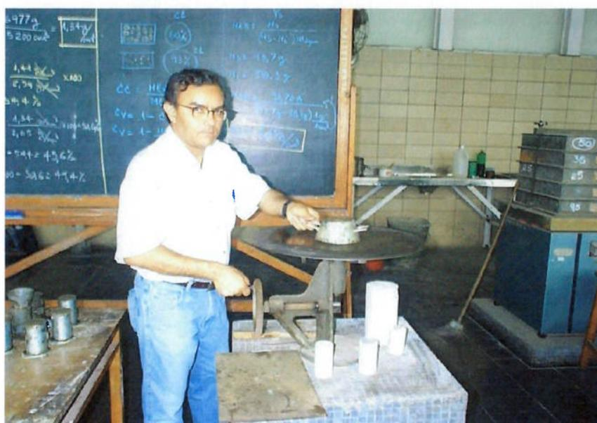
Fig. 49 – Mesa e molde para determinação da consistência de argamassas
