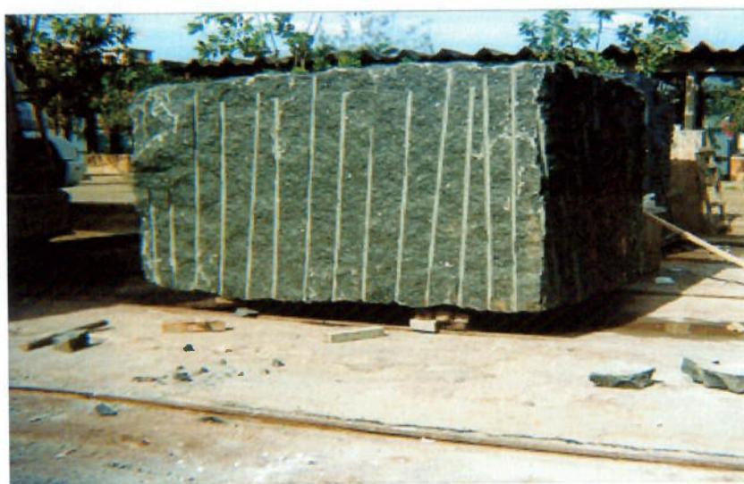
**fig. 14 - Granito verde de Nova Venécia com 2,8 x 2,2x 1,7m**
