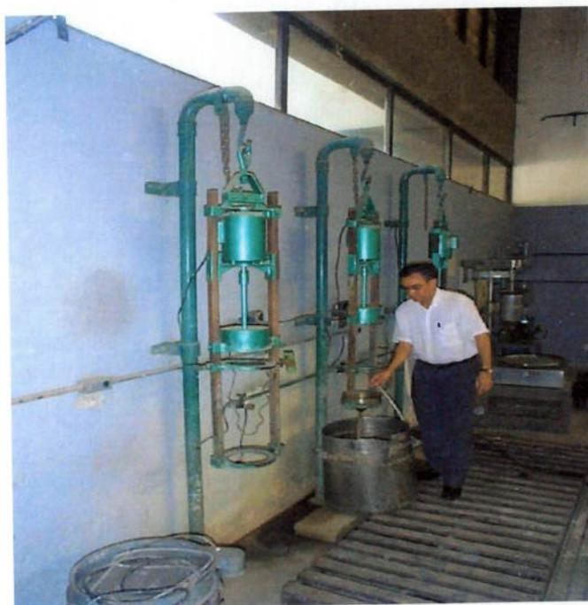
fig. 36 – Peneirador suspenso (via úmida)
