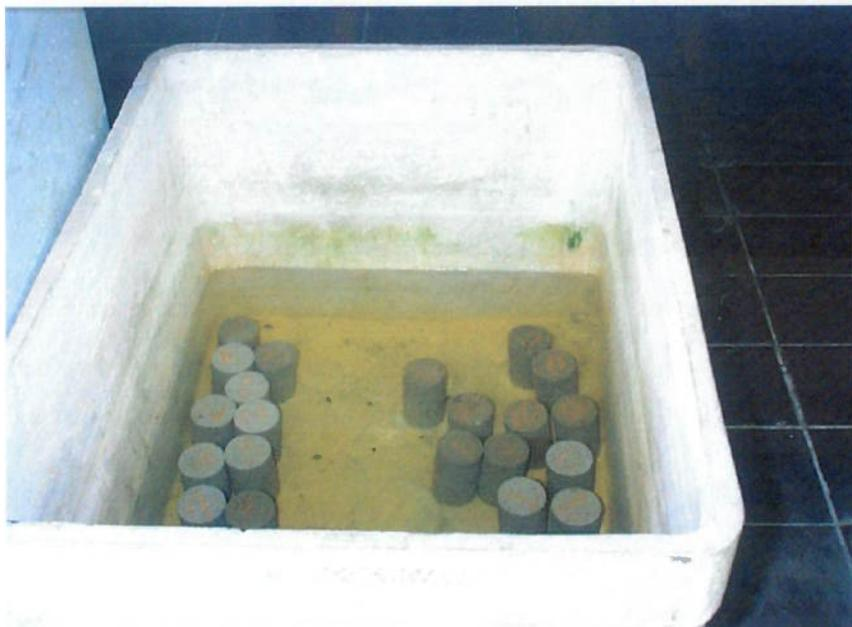
fig 51 – Corpos de prova colocados por 28 dias em cura
